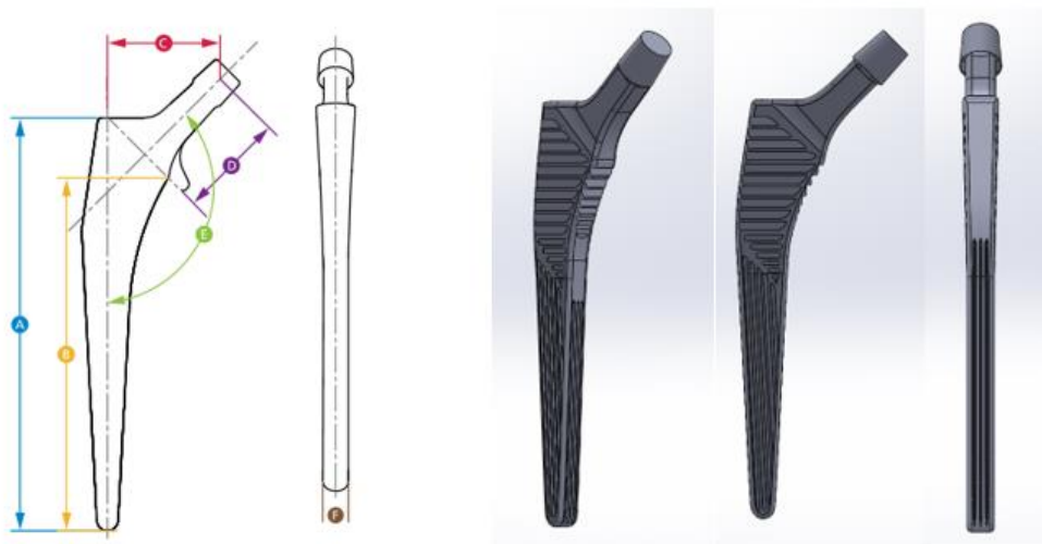
Figura 5.9 – Geometria e modelação da haste Corail [93].
