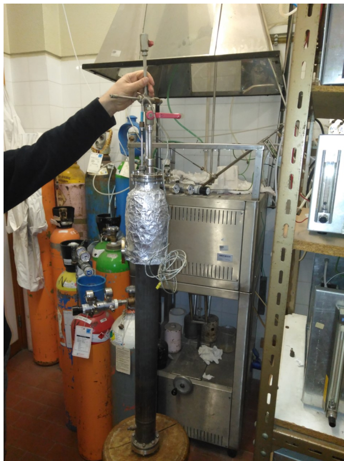
Figura 3.1 – Reator de leito fixo e forno de aquecimento
