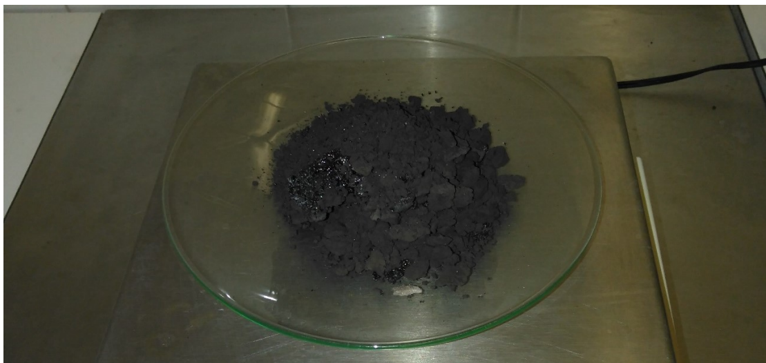
Figura 4.6 – Biochar no final de um ensaio de pirólise lenta
