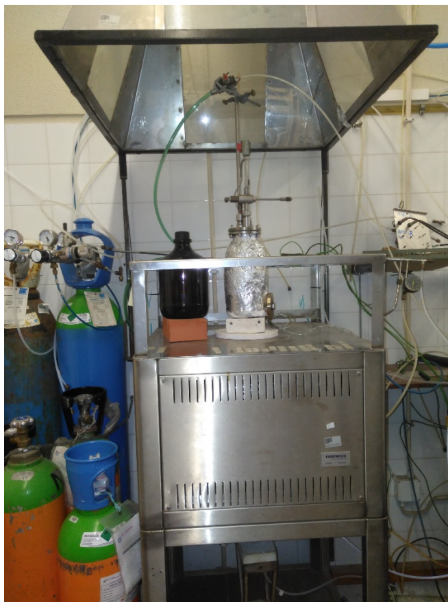
Figura 3.2 – Forno vertical de aquecimento e reactor em posição
