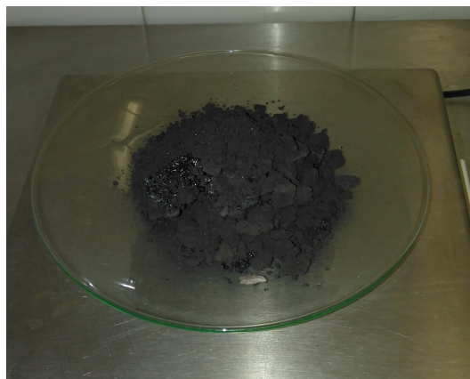
Figura 3.8 – Produto final, biochar depois de um ensaio de pirólise lenta
