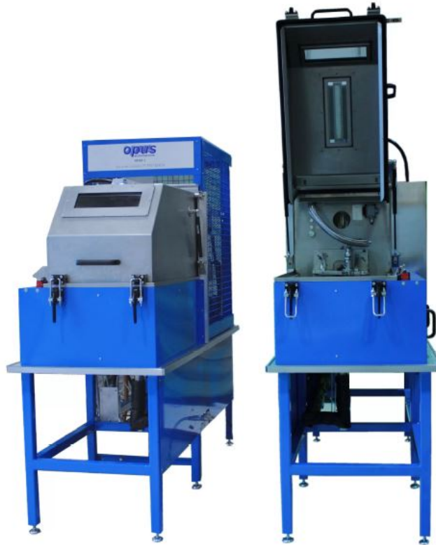
Figura 3.6: Exemplo de bancos de endurance de bombas de óleo. Adaptado de [19].
