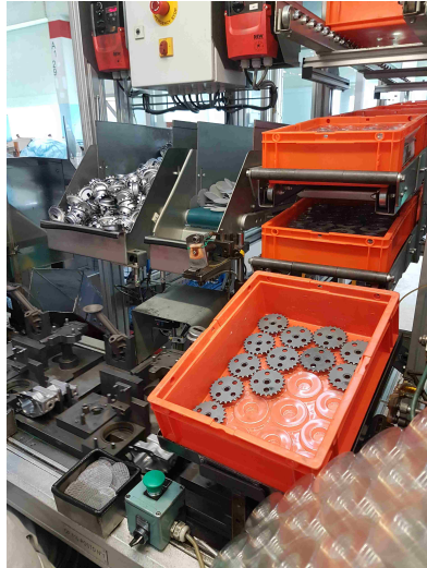
(a): Introdução do pinhão de comando, do filtro de rede e da tampa do filtro de rede.
