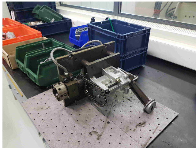
Figura 4.5: Bomba K9 com respetiva montagem suporte para banco de ensaios de endurance.
