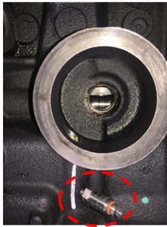
(a): Picagem de pressão à saída da bomba (bloco do motor).
