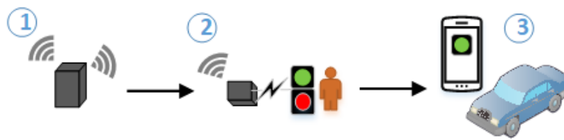
Figura 3.5: Arquitetura do sistema proposto. Em 1 está representado o controlador, em 2 o dispositivo junto da passadeira e em 3 o dispositivo a integrar no interior do veículo.
