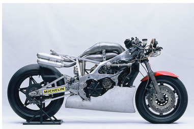
fig. 12 - Mecânica Honda NSR500, 1984
