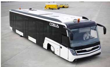
fig. 86 - Autocarro elétrico da CaetanoBus (Cobus), destinado ao transporte de passageiros em aeroporto, 2015
