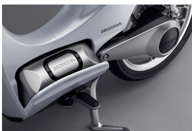
fig. 74 - Sistema de remoção da bateria, Honda EV Cub, 2015
