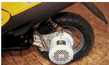
fig. 58 - Famel Electron, 1995. Detalhe do posicionamento do motor
