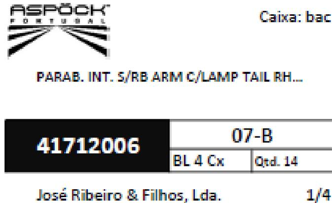
Figura 4.13: Exemplo de kanban utilizado para fluxo de material
