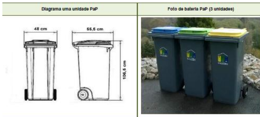
Figura 5.3 - Tipologia dos contentores utilizados para o projeto de alargamento PaP.
