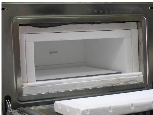
Figura 3.21 – Imagem do interior do forno, com refratário para isolamento térmico e termopar.
