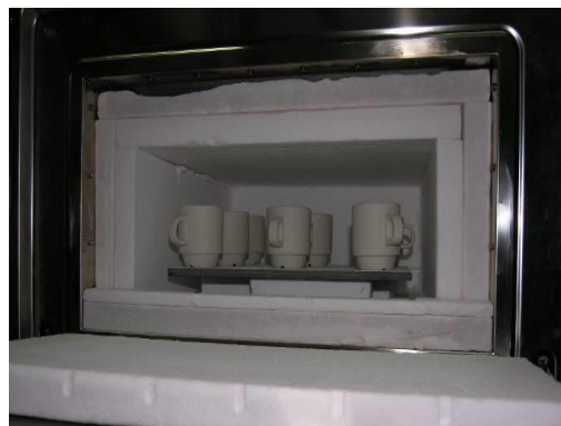
Figura 3.22 – Forno com carga de cerâmica sobre uma placa de carboneto de silício.
