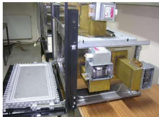
Figura 3.20 – Imagem dos magnetrões instalados.
