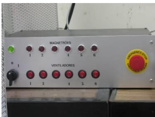
Figura 3.23 – Sistema de controlo.
