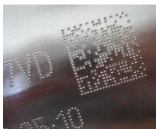
Micro percussão (Technifor - Gravotech Marking, 2017b)
