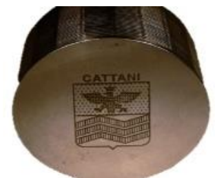
Gravação eletroquímica (Mecalux logismarket, 2017)
