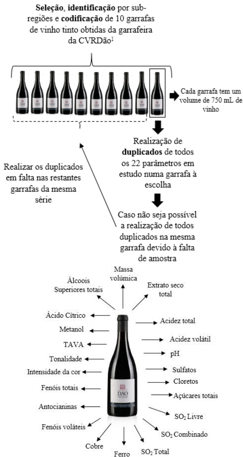
Figura 18- Diagrama de trabalho realizado no laboratório da 1 Comissão Vitivinícola Regional do Dão e parâmetros físico-químicos analisados em cada garrafa em estudo.
