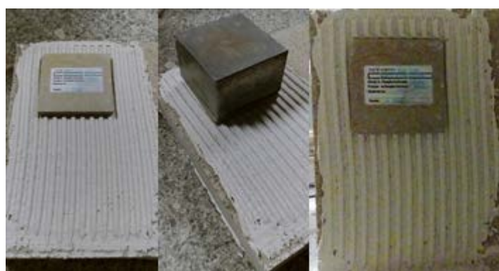
Figura 7 - Ensaio de deslizamento vertical
