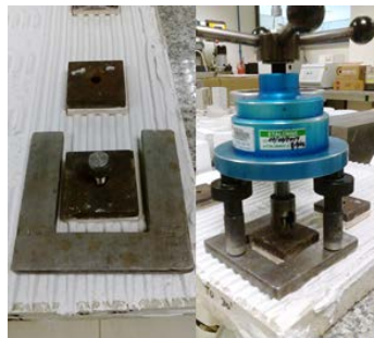
Figura 9 - Dinamómetro e ferramentas utilizadas para realizar o ensaio de aderência
