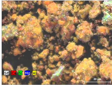
Figura B 3 - Imagem de SEM do CAC, com o mapeamento dos respectivos elementos químicos detetados em EDS, para um tempo de cura de 16 meses
