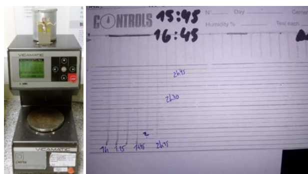
Figura 11 - Exemplo de um aparelho Vicat e respetiva folha de registo
