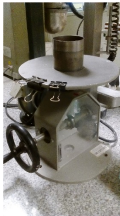
Figura 5 - Mesa de medição de consistência e copo cilíndrico utilizados para a medição da massa volúmica aparente da pasta
