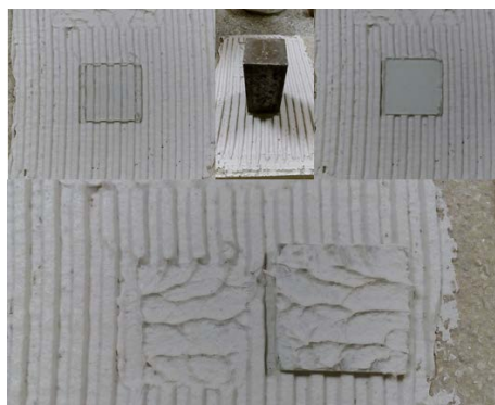
Figura 8 - Avaliação do poder molhante e transferência de uma cola
