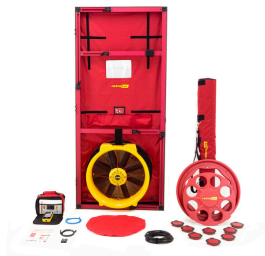
Figura 16 – Equipamento de ensaio com Porta Ventiladora
