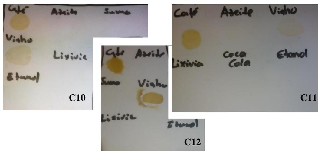
**Figura C4.4** – Manchas visíveis sobre os revestimentos C3 a C5, depois do teste com químicos, a 1 hora.
