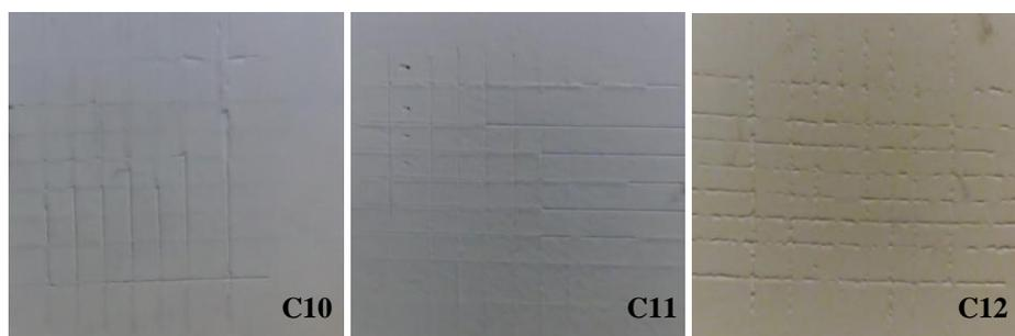
**Figura 27-** Cortes observados, no teste de aderência, nas amostras dos revestimentos C10, C11 e C12.
