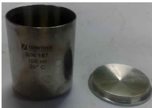
**Figura 13** – Picnómetro metálico de 100 mL, utilizado na determinação da densidade das formulações.
