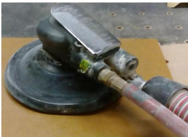
**Figura 14** – Lixadeira mecânica, utilizada para lixar as amostras dos substratos de madeira usados.
