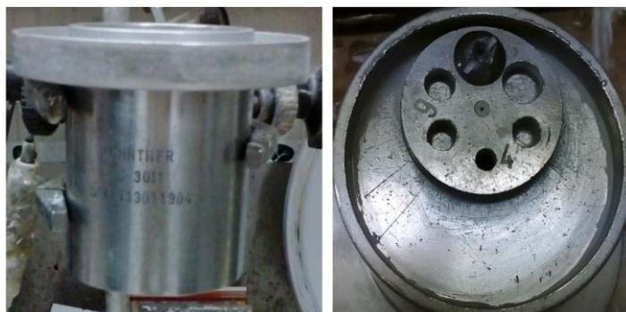
**Figura 12** – Copo DIN, com orifício de 4mm, utilizado na medição da viscosidade das formulações.
