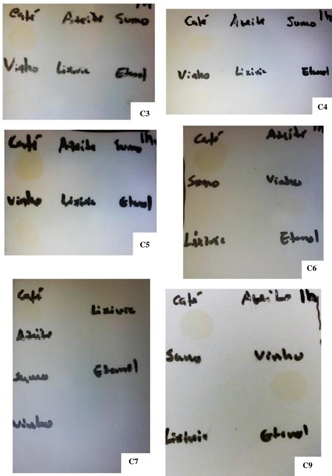
**Figura C4.2** – Manchas visíveis sobre os revestimentos C3, C4, C5, C6, C7 e C9 a C9, depois do teste com químicos, a 1 hora.
