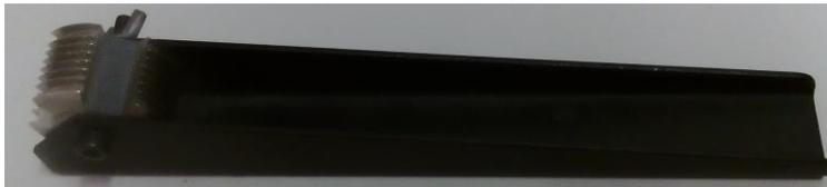
**Figura 17** – Aparelho de corte composto por 6 lâminas, utilizado para obter uma malha quadriculada para a realização do teste de aderência.
