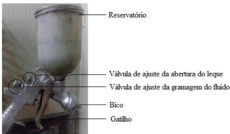
**Figura 15** – Pistola utilizada para aplicação das formulações dos revestimentos nas amostras de substrato.
