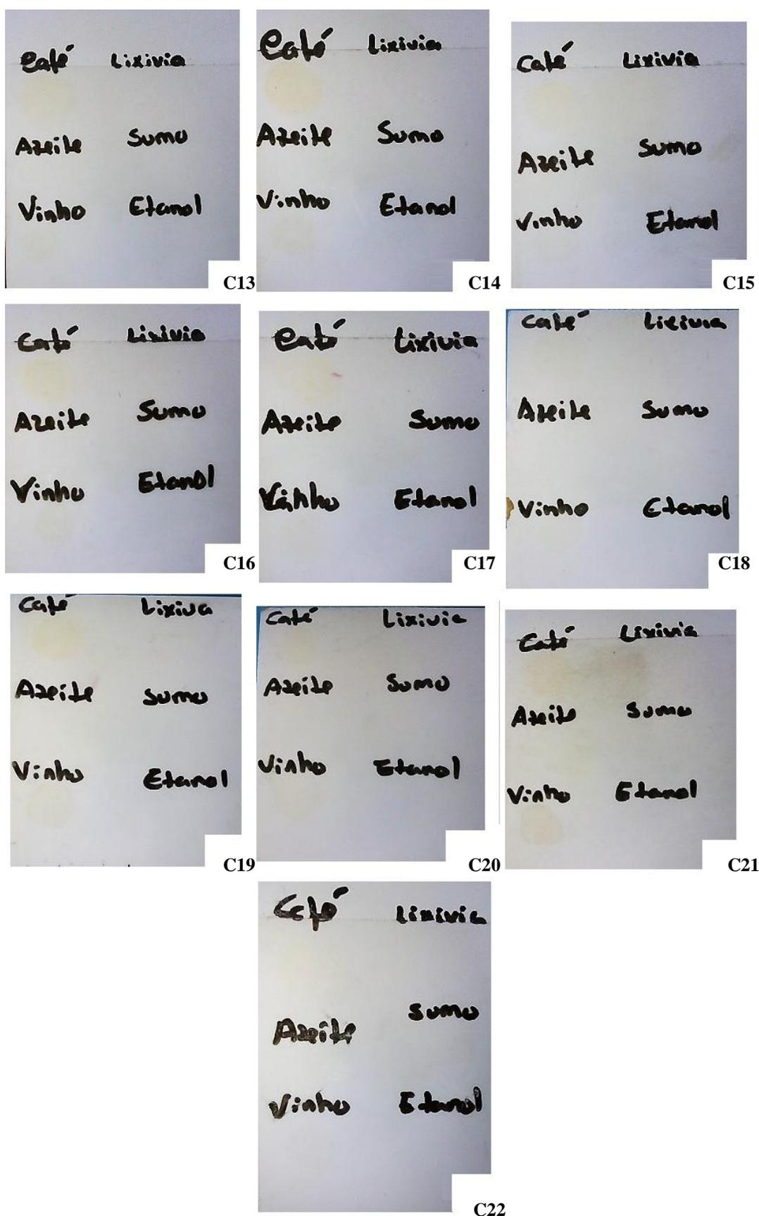
Figura C4.5 – Manchas visíveis sobre os revestimentos C13 a C22, depois do teste com químicos, a 1 hora.
