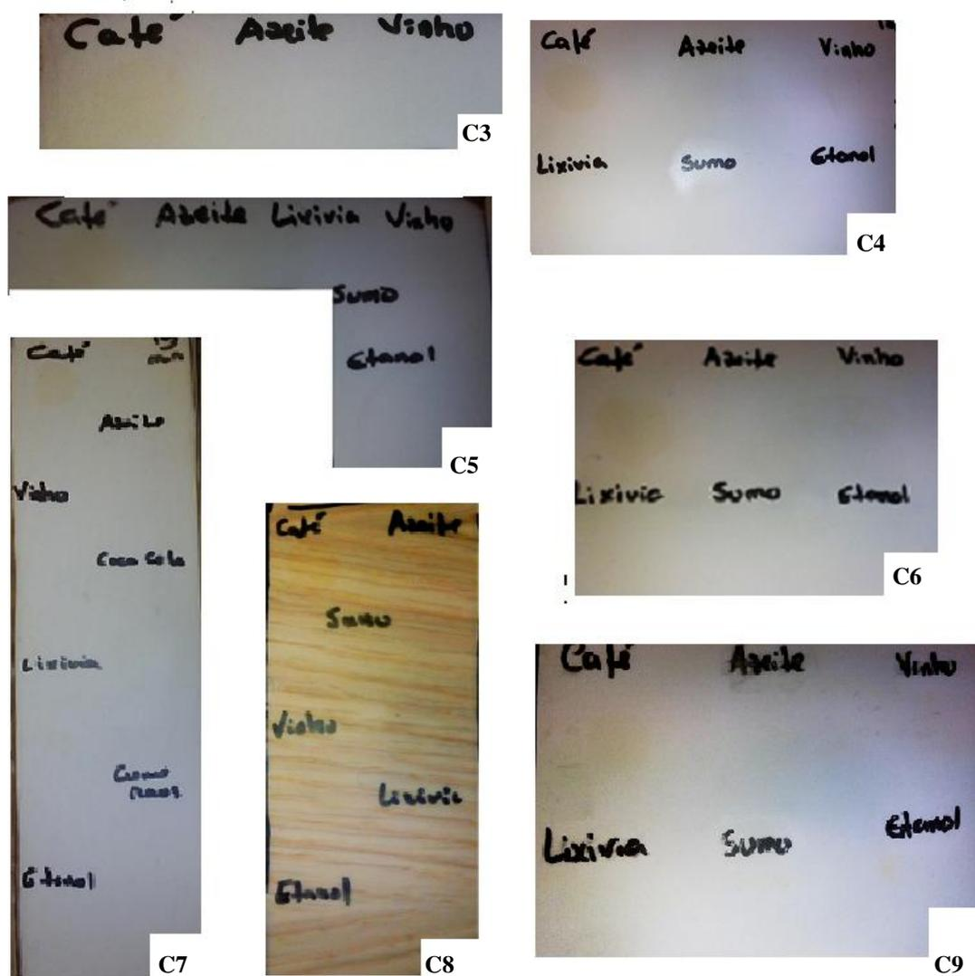
Figura C4.1 – Manchas visíveis sobre os revestimentos C3 a C9, depois do teste com químicos, a 15 minutos.
