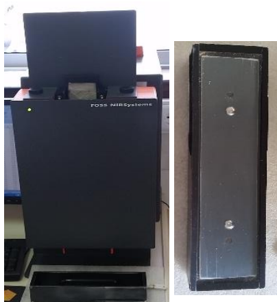
Figura 7 NirSystems 5000 e célula de análise retangular utilizados para análise de alimentos Pet Food.
