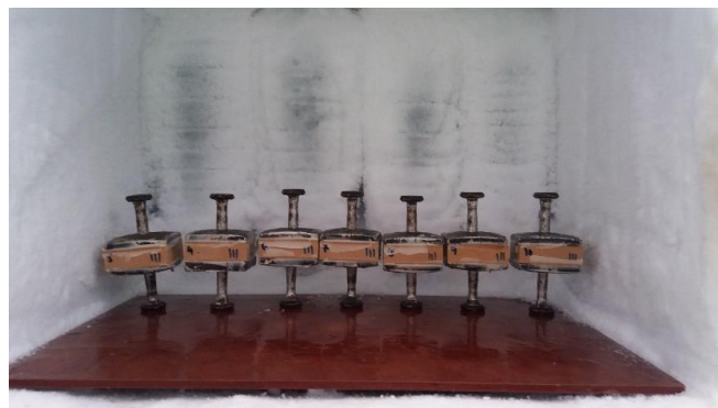
Figura 10 - Estabilização da temperatura dos provetes após colagem no suporte metálico na arca.
