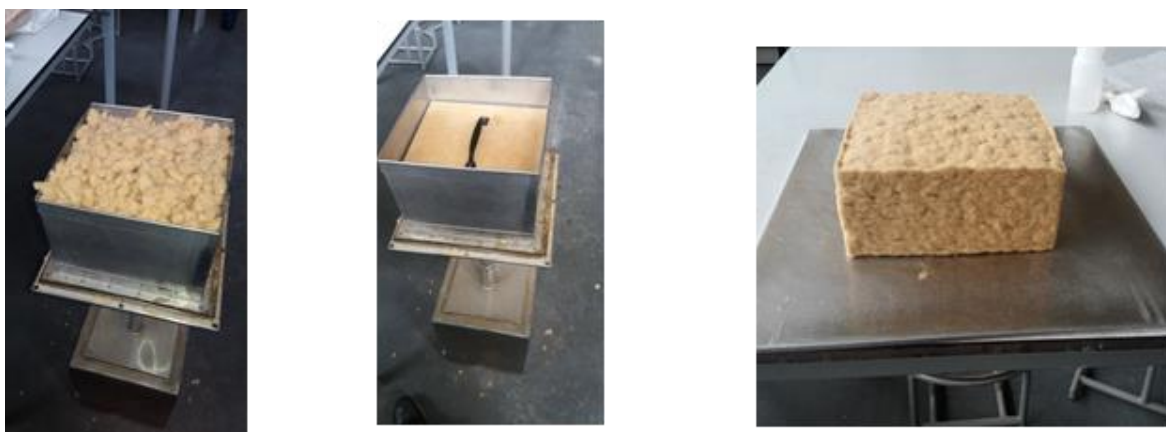
Figura A. 3 - Formação do colchão de fibra com o auxílio da formadora.
