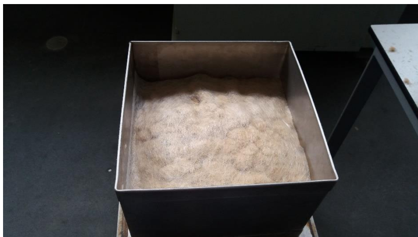
Figura A. 4- Adição da folha fibra de vidro, no processo de formação do colchão.
