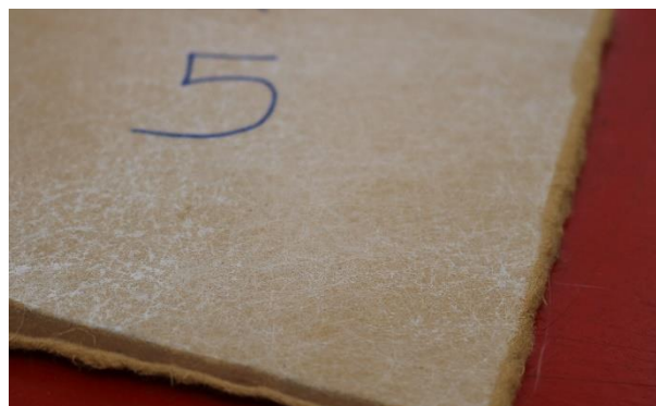
Figura 26 - Placa número 5 produzida laboratorialmente com fibra de vidro e impregnação com 100% de resina.
