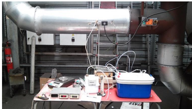
Figura 32- Montagem do sistema de amostragem da Experiência 1.
