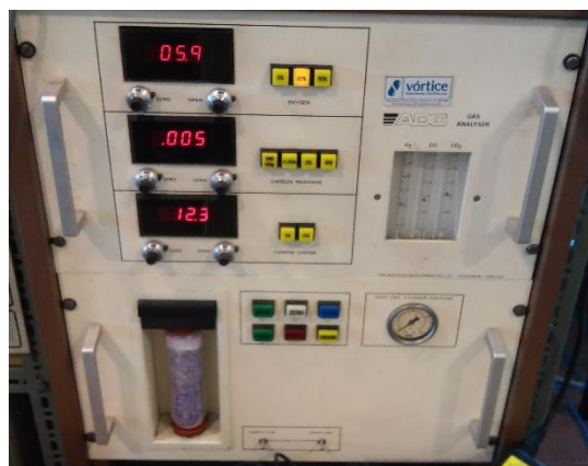
Figura 33- Analisador online (ADC WA-558G) utilizado para os gases secos CO, CO 2 e O 2 .
