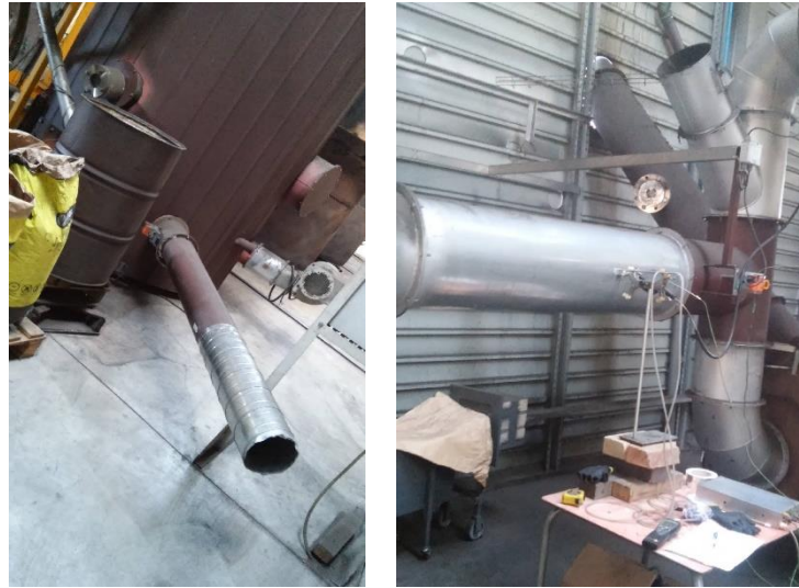
Figura 27 - Condução da entrada de ar na câmara de combustão (lado esquerdo) e condução dos gases de exaustão (lado direito).
