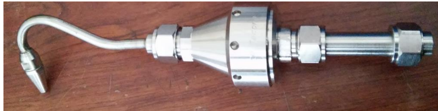
Figura 37- Sonda de amostragem de partículas (Sonda TCR Tecora).
