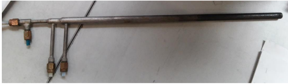
Figura 31- Sonda utilizada para a amostragem dos gases secos de exaustão (CO, CO 2 e O 2 ).
