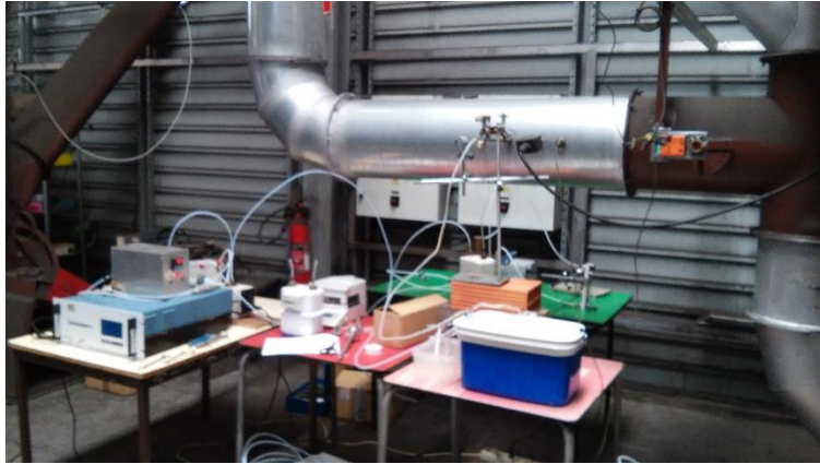
Figura 35- Montagem do sistema de amostragem da Experiência 1.
