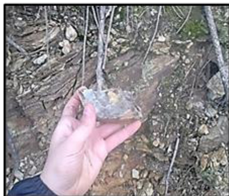
Figura 2.8 - (A) Falha observada, também reconhecida na cartografia, sendo assumida pela mudança de direção do afloramento e mesmo no estado de meteorização da litologia, surgindo quartzofilito (em (B)) e filito (em(C)).
