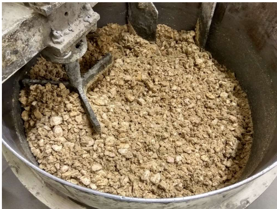
Figura 33 – Execução de um ensaio de betão, momento que se se adiciona parte da água aos agregados da amassadura.
