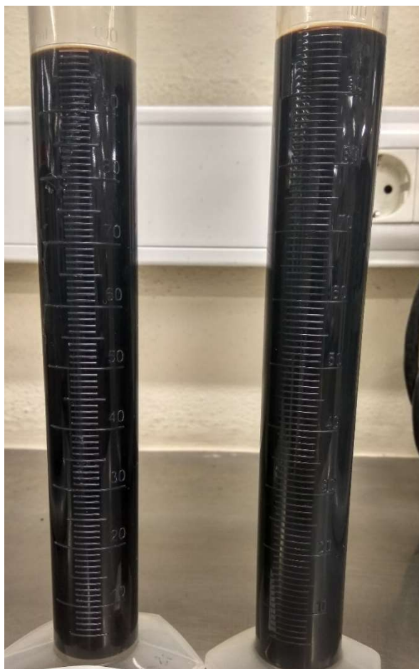
Figura 14 – Resultados obtidos após fabrico de adjuvante com adição de 3,5% do A13 sobre o peso do lenhosulfonato (à esquerda) e adição de 3,5% do mesmo aditivo ao adjuvante já formulado (à direita).
