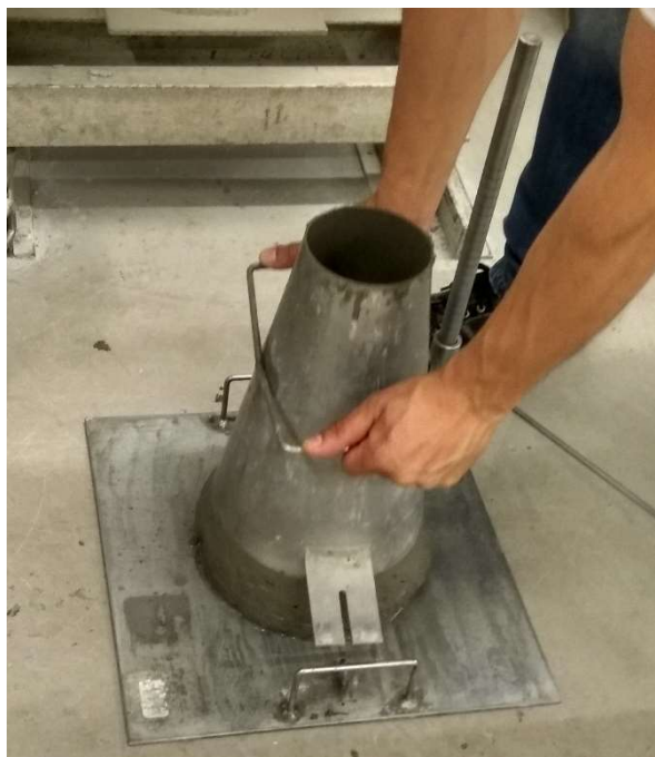
Figura 36 – Execução do ensaio de abaixamento, momento em que se retira o cone de Abrams .
