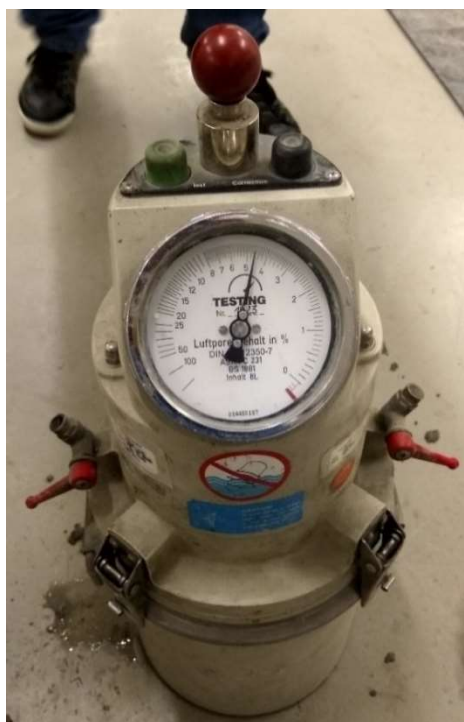
Figura 38 – Aerómetro, equipamento utilizado para medir o teor de ar em betão fresco.
