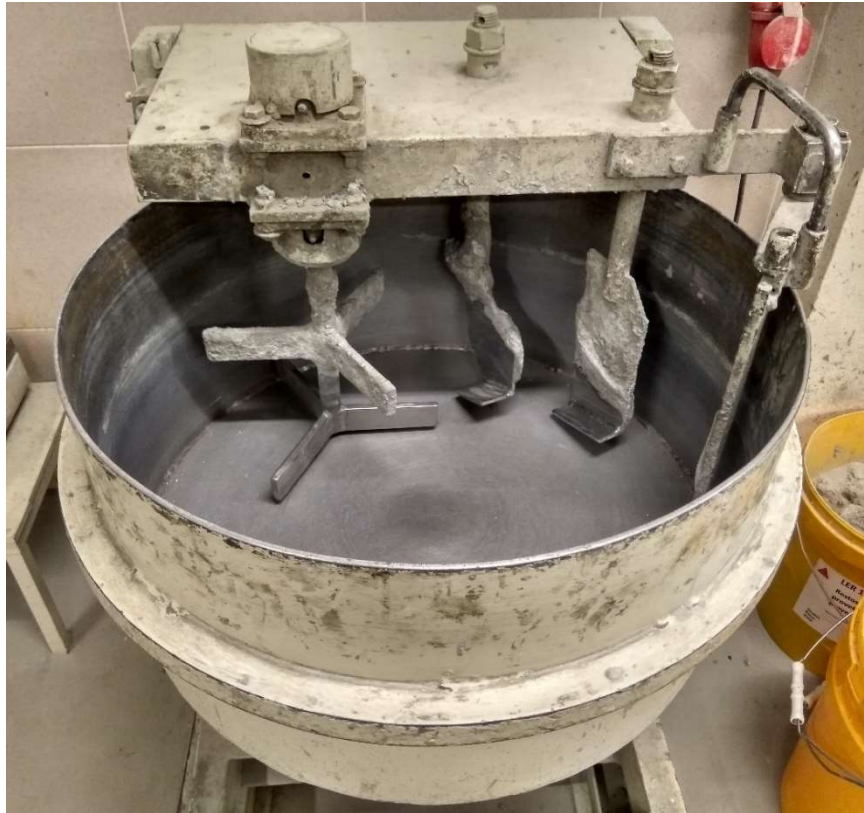
Figura 32 – Misturador utilizado na amassadura do betão.
