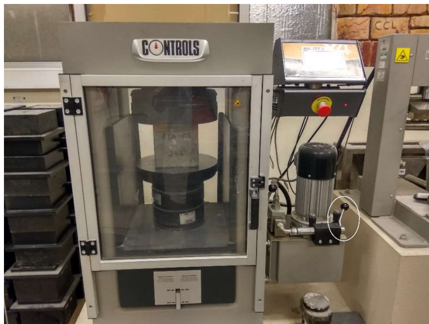
Figura 41 – Prensa utilizada nos ensaios de tensão de rotura à compressão, onde o provete é introduzido dentro do equipamento. Do lado direito da imagem é possível observar no topo, onde são feitos os registos da força e tensão de rotura, e mais abaixo (rodeado a branco) situa-se o manípulo hidráulico.
