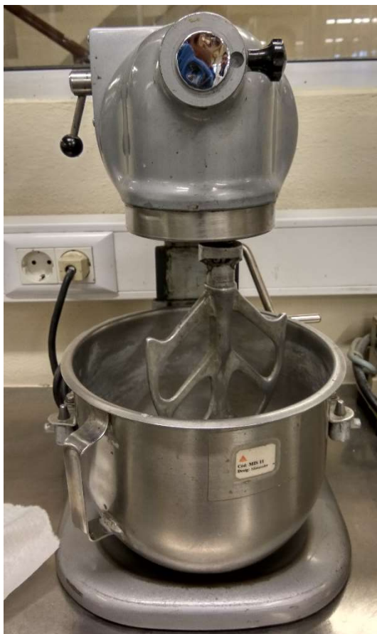
Figura 26 – Misturador utilizado na amassadura das argamassas.
