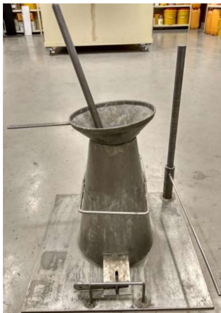
Figura 35 – Cone de Abrams , utilizado no ensaio de abaixamento em betão fresco, juntamente com a respetiva base, o pilão e a escala.
