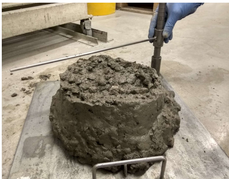
Figura 37 – Execução do ensaio de abaixamento em betão fresco, momento de medição do abaixamento.
