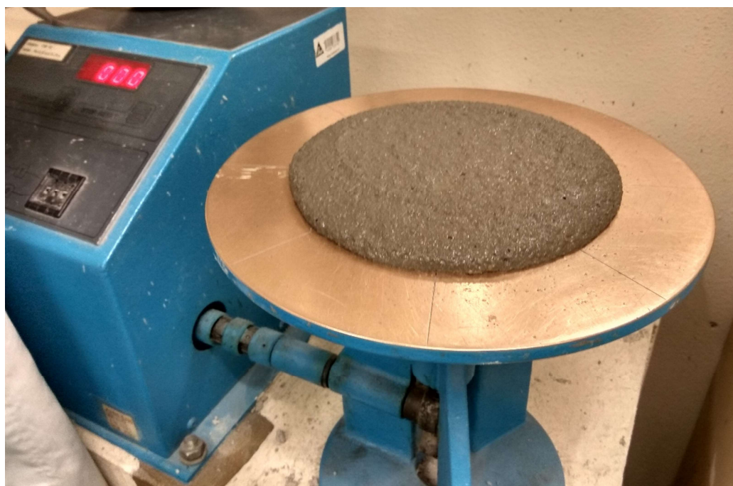
Figura 31 – Realização do ensaio de espalhamento de argamassa.
