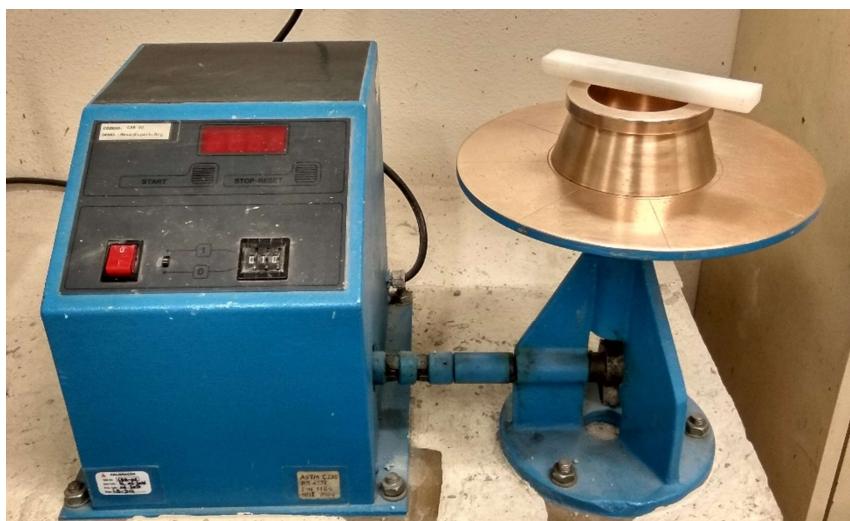
Figura 30 – Mesa de espalhamento utilizada no ensaio de espalhamento de argamassas, juntamente com o cone e o pilão.
