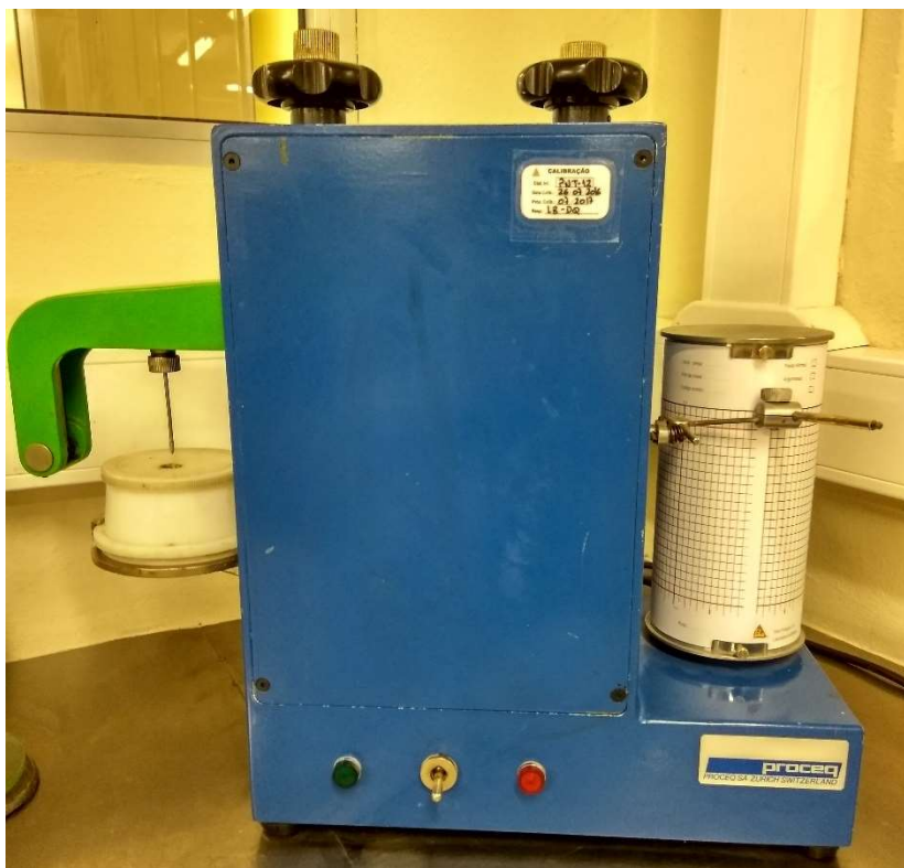
Figura 28 – Penetrómetro automático utilizado para prever o tempo de início de presa das argamassas.
