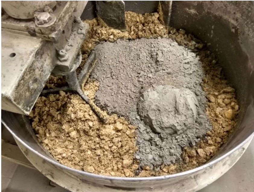
Figura 34 – Execução de um ensaio de betão, momento em que se adiciona o ligante (cimento e cinzas volantes) à amassadura.
