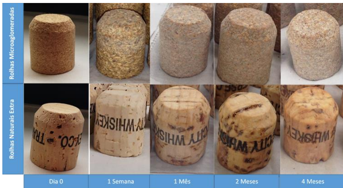
Figura 19 – Aparência das rolhas depois de estarem em contacto com uma solução de alto teor alcoólico por vários períodos de tempo.
