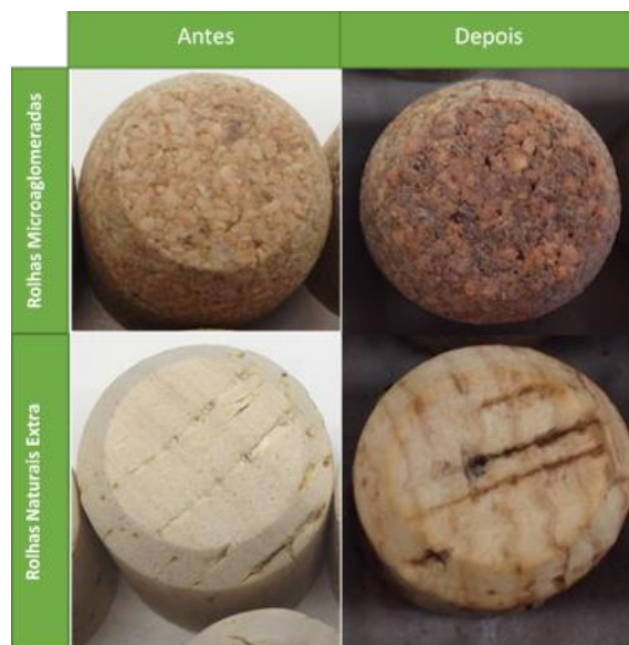
Figura 20 – Topos das rolhas. Nesta figura pode observar-se o aparecimento de fissuras nas rolhas NeutroTop® depois do ensaio terminado.
