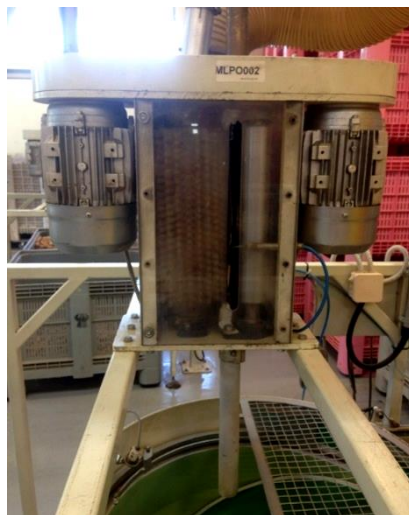
Figura 11 – Montagem experimental da tecnologia de despoejamento de aspiração e escovas.
