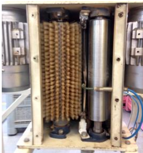
Figura 17 – Montagem do equipamento de despoiramento com escovas e aspiração.
