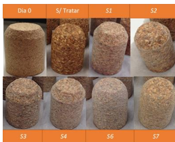
Figura 24 – Alteração de aspeto das rolhas após um mês de ensaio.
