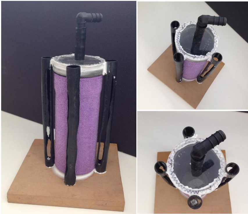
Figura A. 2 - Maquete do protótipo inicial para o sistema de despoejamento – coluna de aspiração e microfibras.
