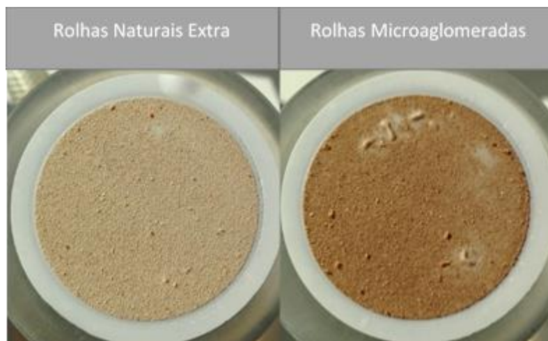
Figura 22 – Filtros com as partículas retiradas do líquido, após um mês, em contacto com as rolhas.
