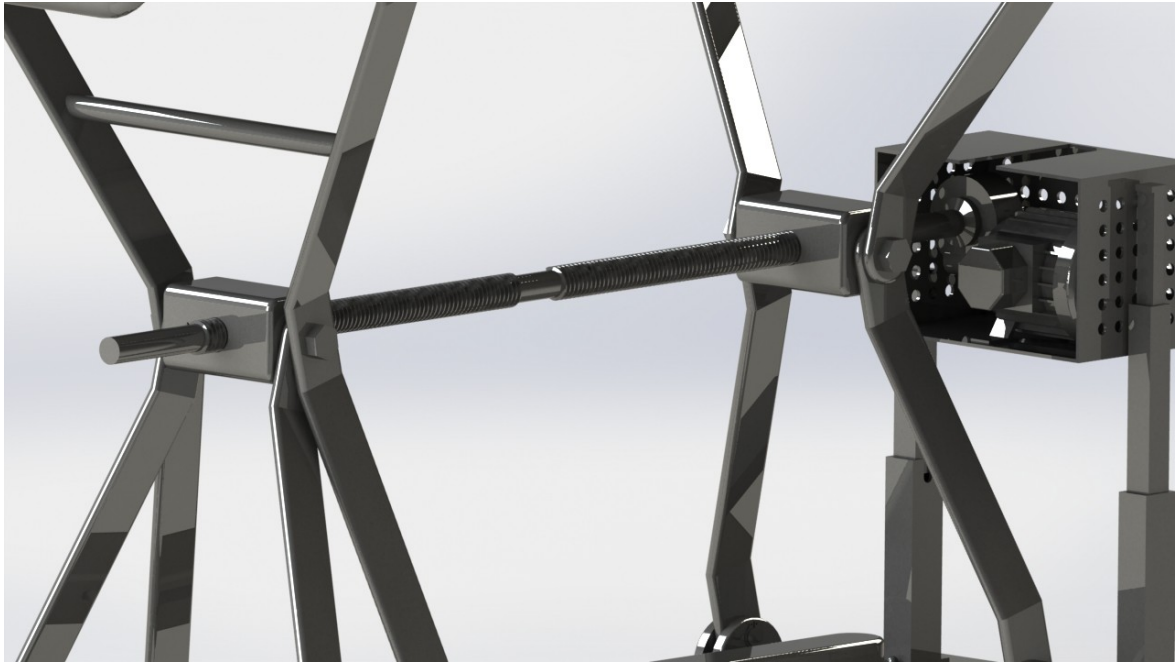
Imagem 16 – Demonstração do fuso alinhado com as caixas das roscas e restantes artefactos
