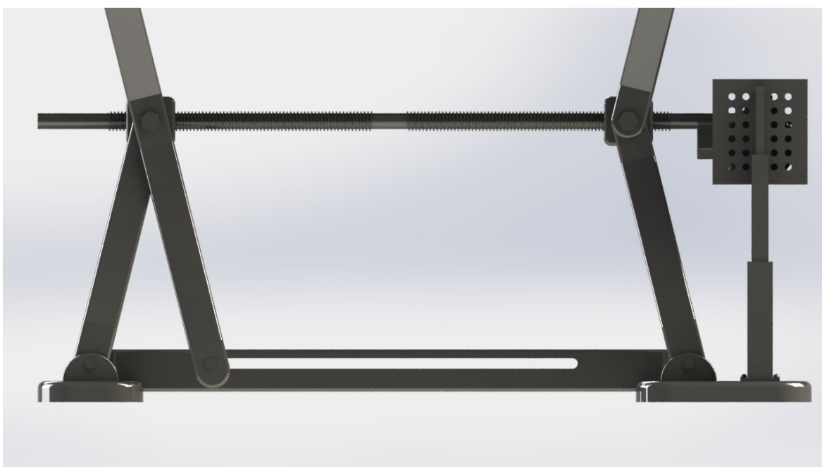
Imagem 13 – Demonstração do eixo de ligação inferior (guia)
