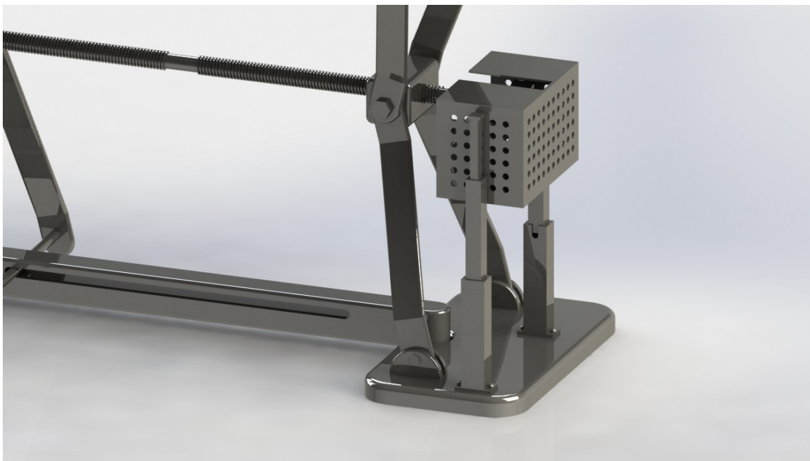
Imagem 15 – Demonstração das calhas verticais que sustentam a caixa que acopla o moto-redutor (calha em posição máxima vertical)
