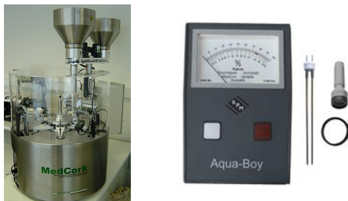
Figura 8 – À esquerda, Medcork utilizado no ensaio dimensional e determinação de humidade; à direita, Aqua-Boy equipamento de medição de humidade
