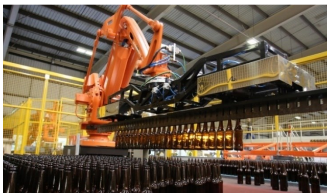
Figura 2.4 Processo de paletização das garrafas de vidro. 60
