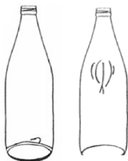
Figura 2.13 Exemplos de padrões de fratura resultantes de carga vertical. 38
