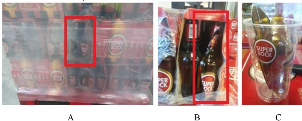
Figura 1.4 Exemplo de uma embalagem com garrafa partida numa palete de produto acabado. A - Palete com garrafa partida; B - Pormenor da embalagem com garrafa partida; C - Garrafa partida depois de retirada da embalagem.
