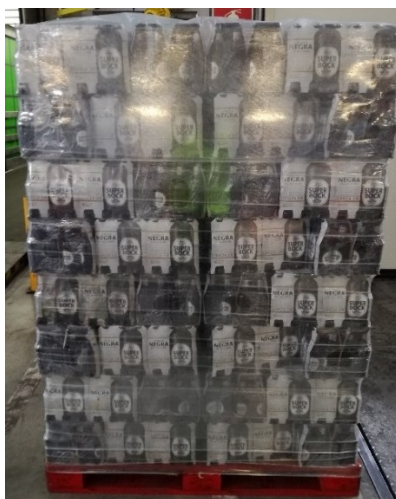
Figura 2.8 Esquema de paletização a 180°.
