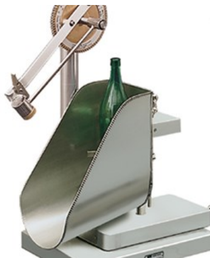
Figura 3.9 Aparelho de medição utilizado para o teste de impacto. 43
