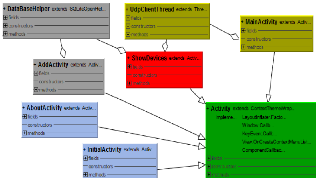
Figura 4.8: Diagrama UML - Aplicação HygrothermalAppUA
