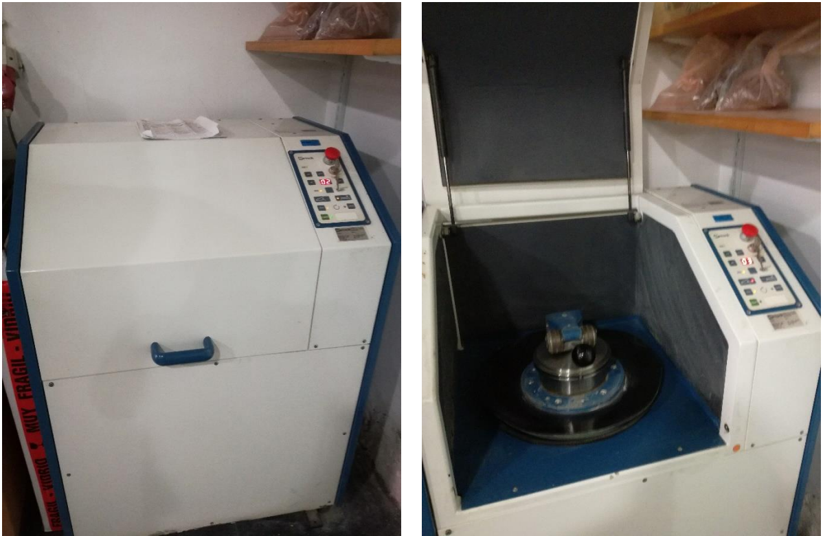
Figura 16 - Moinho de argolas/anéis de ágata
