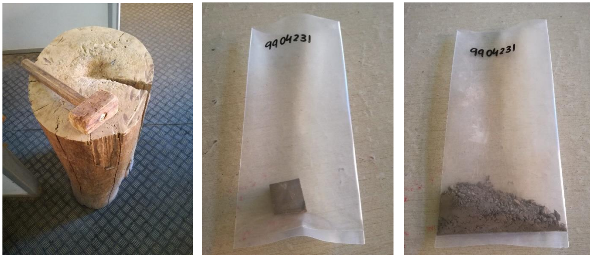
Figura 15 - Processo de desagregação a amostra
