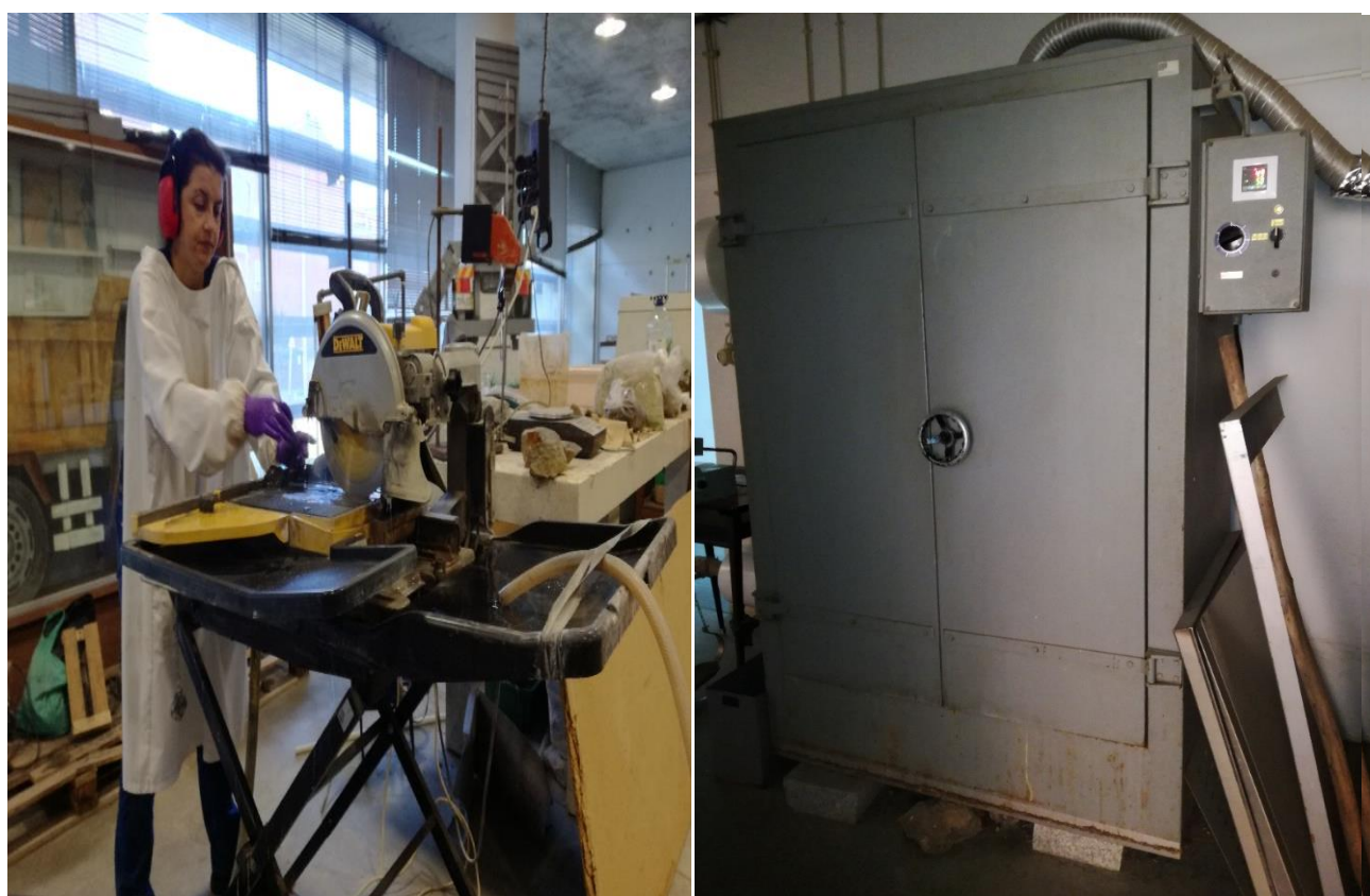
Figura 14 - Equipamento para cortar as taliscas e estufa em que foram colocadas as amostras para secar a 50°C durante 24 horas
