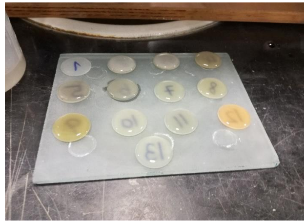
Figura 18 - Etapas da realização das lâminas para análise difratométrica
