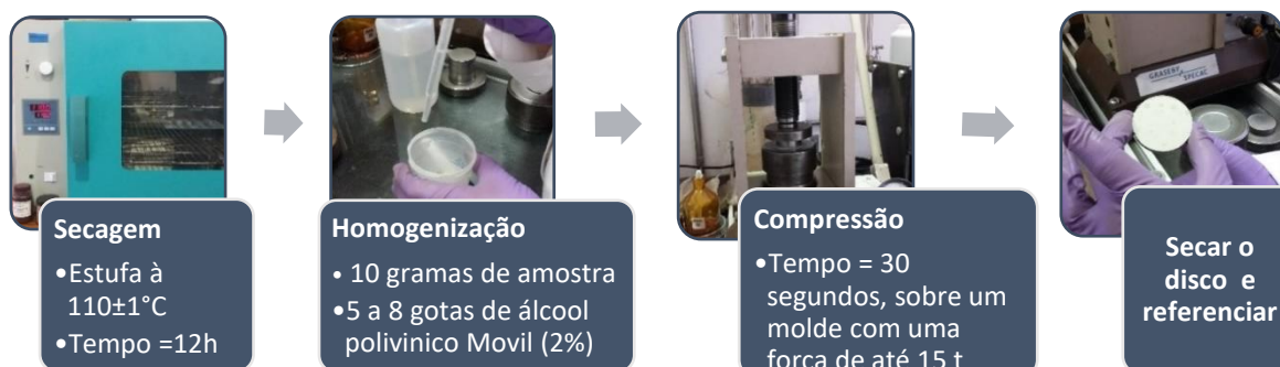
Figura 17. Procedimento experimental para a execução de um disco prensado.
