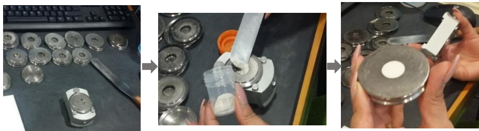
Figura 21. Procedimento experimental para a execução da técnica da difração de raios-X.
