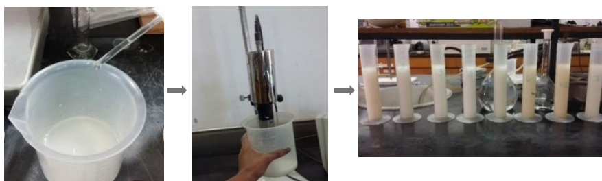
Figura 22. Procedimento experimental para a execução da lei de Stokes.
