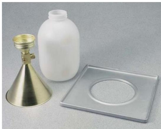
**Figura 30-** Equipamento para realizar o ensaio da garrafa de areia (A. Santos, 2008)
