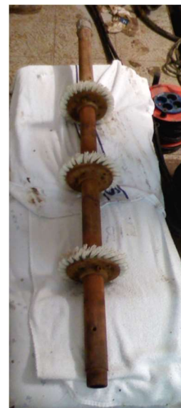
Figura 6.11 - Esquema do dispositivo das escovas de limpeza e fotografia de uma escova de limpeza.
