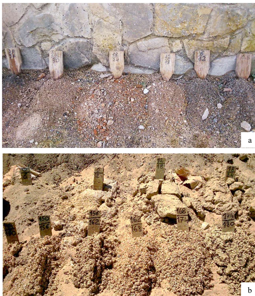
Figura 5.13 - Exemplo da disposição da amostragem das formações geológicas atravessadas e respectivas etiquetas. (a) Resultantes do método rotopercussivo; (b) Resultantes do método Rotativo por circulação direta.
