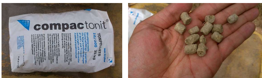
Figura 4.9 - Compactonite, bentonite de alta expansividade em pellets.
