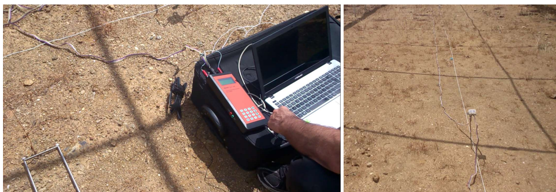
Figura 3.7 - Pormenor de uma linha de aquisição de resistividade elétrica
