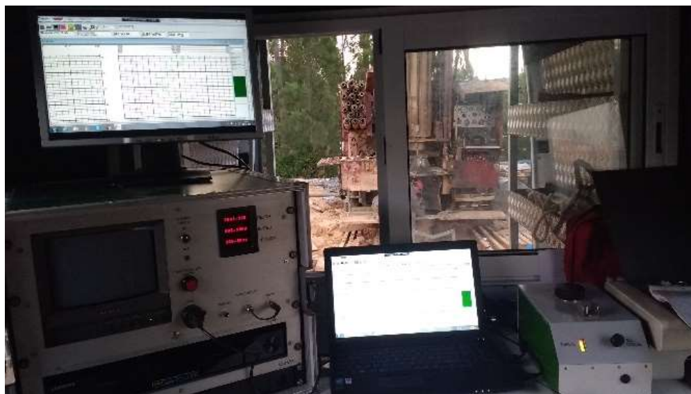
Figura 5.14 - Equipamento de registo de diagrafias (potencial espontâneo, resistência pontual, resistividade eléctrica (normal curta e longa) e radiação gama natural).
