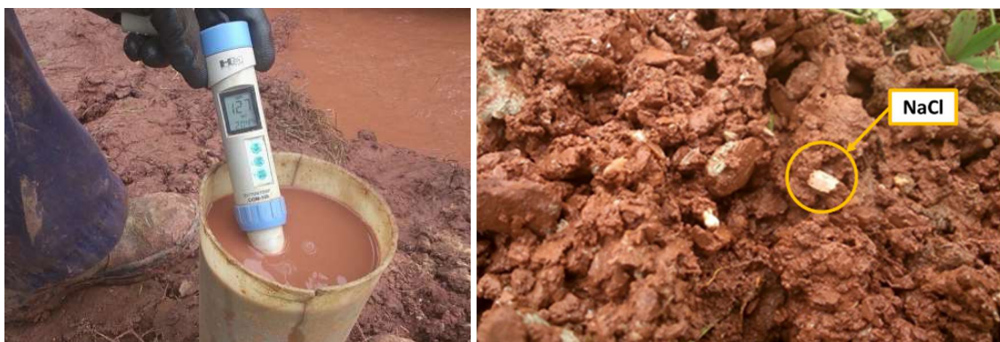
Figura 5.12 - Fluido com elevada concentração de NaCl (1270 ppm), confirmação da presença do mesmo na amostragem.
