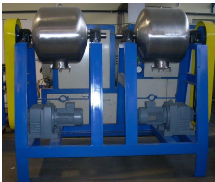
Figura 21- Fotografia de dois moinhos de bolas utilizados na empresa Palbit S.A. com uma capacidade de 200kg.
