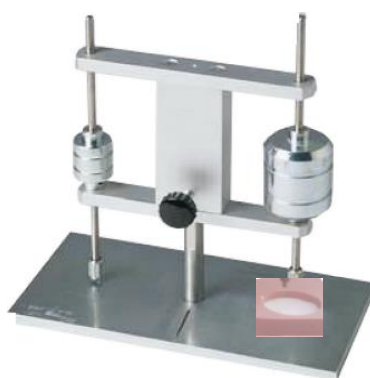
Figura 5: Agulha de Gilmore e molde de silicone com o cimento para a medição dos tempos de presa.
