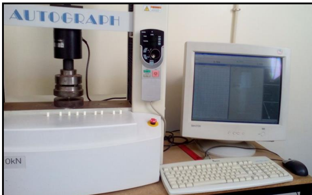
Figura 6: Equipamento Shimadzu Autograph Trapezium 2 utilizado para os ensaios mecânicos das amostras cimentícias cilíndricas.
