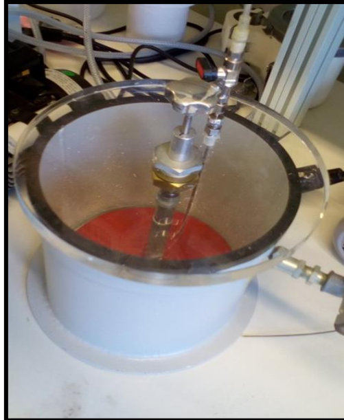
Figura 8: AVE-High Vacuum Engineers- Equipamento utilizado para o enchimento das microagulhas
