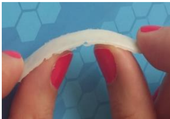
Figura 19 – Provete de PC20F produzido por fusão.
