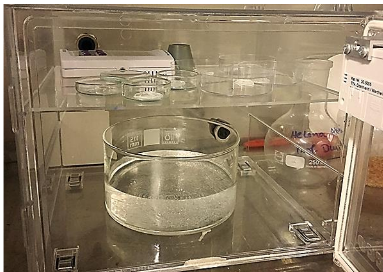
Figura 20 - Câmara utilizada para medição das isotérmicas de sorção, contendo os filmes de PC20F e a solução aquosa saturada.
