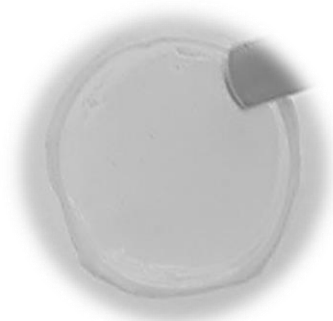
Figura 18 – Filme de PC20F produzido por evaporação de solvente.
