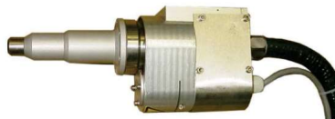
Figura 3.5: Bocal rotativo RD1004 [62]
