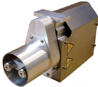
Figura 3.4: Bocal rotativo RD2005 [62]
