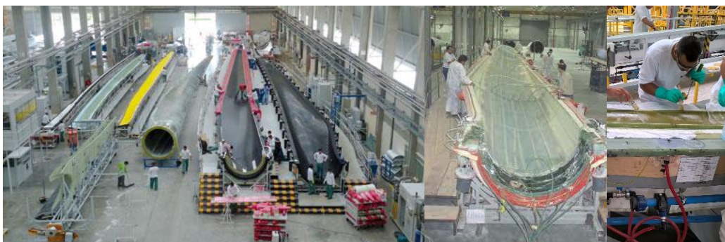
Figura 1-Fotografias do interior da fábrica e dos moldes das pás eólicas [2].
