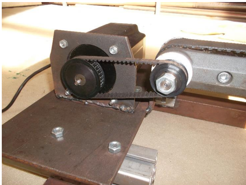
Figura 4.8: Transmissão de potência por correia dentada.
