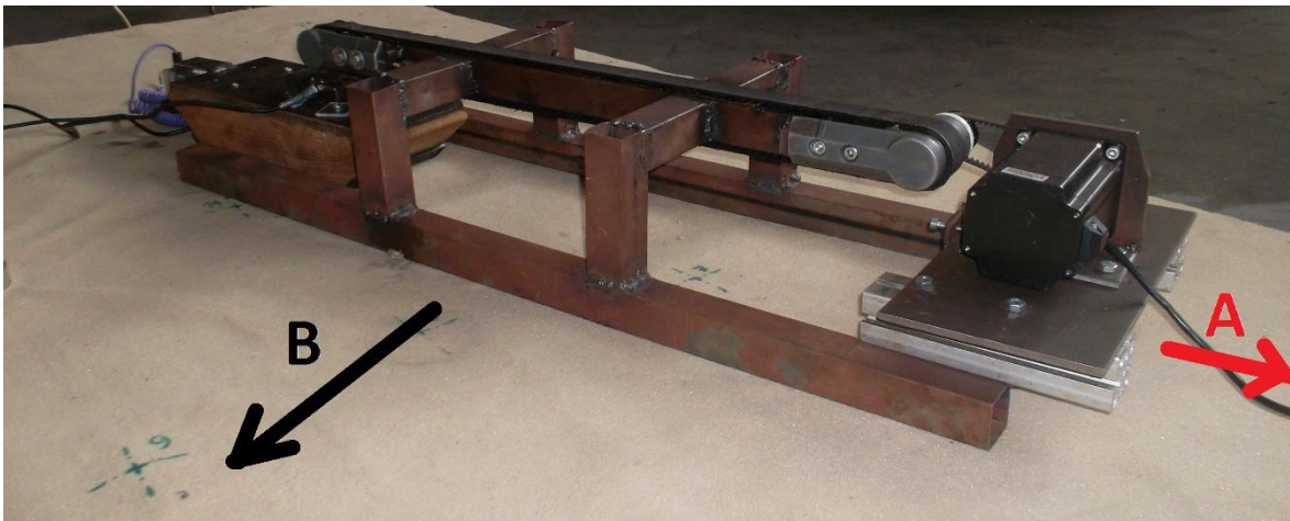
Figura 5.7: Máquina de ensaios de atrito em posição de teste, com representação das direções A e B testadas.
