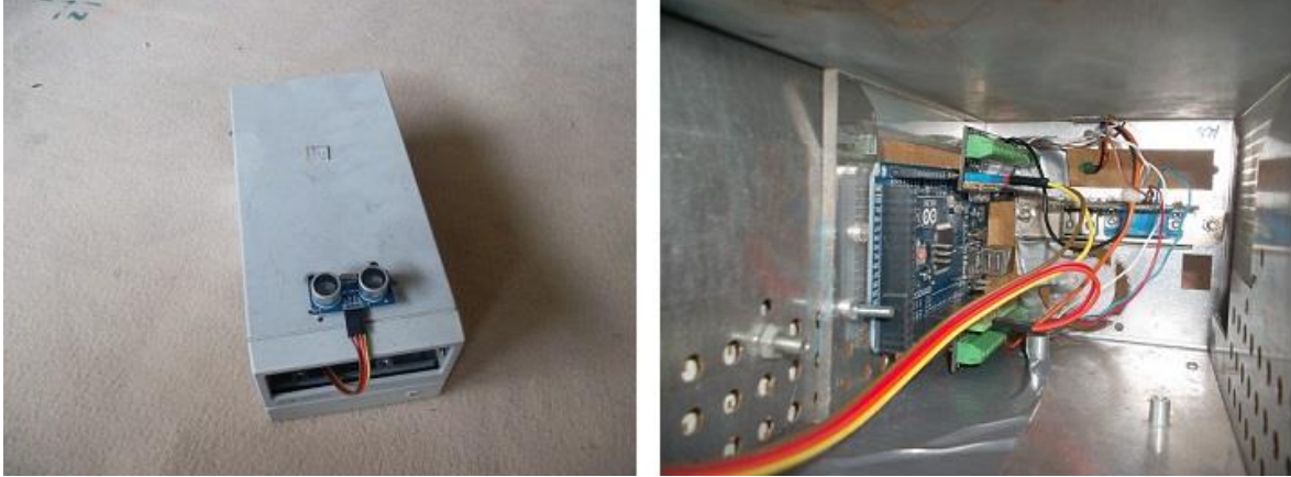
Figura 3.10: Sistema de aquisição de posição antigo (à esquerda vista do exterior, à direita vista do interior).
