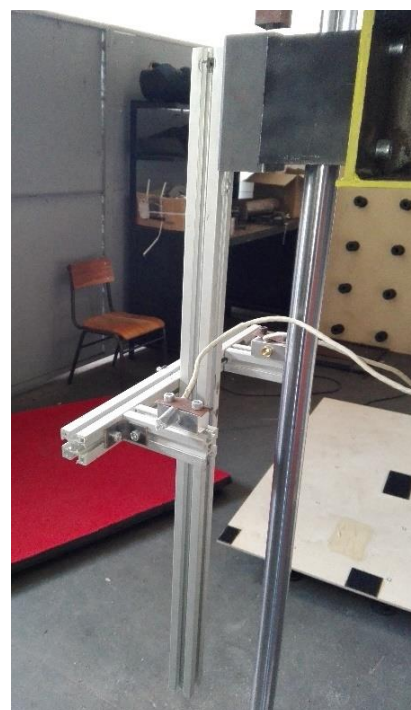
Figura 4.9-Sistema de paragem automática do guincho.
