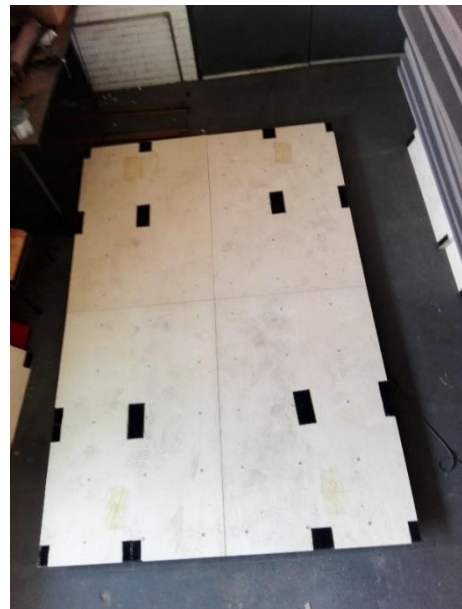
Figura 4.21-Vista frontal das quatro placas de madeira inferiores com bandas de velcro (dimensões 2000 mm × 3000 mm)
