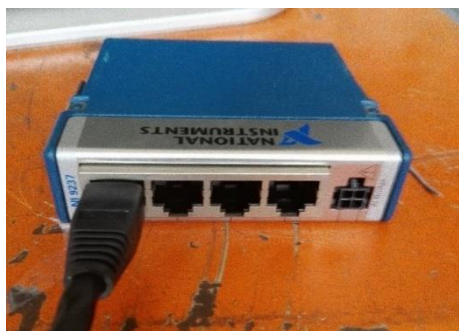
Figura 4.16-Placa de aquisição de dados NI9237 Figura 4.17- Chassis CompactDAQ da National Instruments ® com cartas NI9237 e NI9215.
