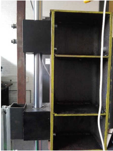
Figura 4.2-Sistema de suporte e guiamento impactor.
