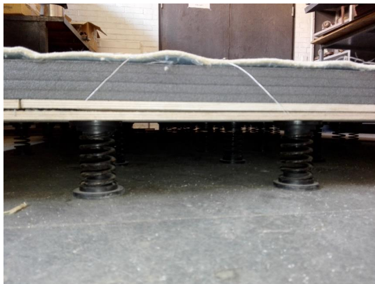
Figura 4.19-Estrutura da amostra de piso de ginástica artística (tipologia 1): no sentido ascendente encontram-se as molas helicoidais; as placas de madeira inferiores; as placas de madeira superiores; os colchões de espuma polimérica de quatro camadas; alcatifa (vista lateral).
