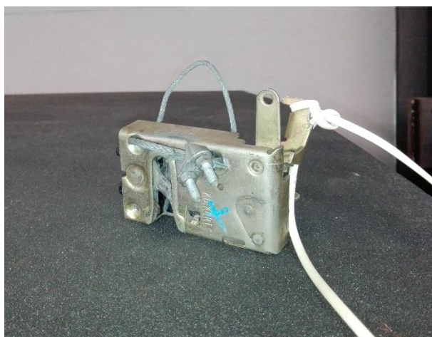
Figura 4.8-Mecanismo de fixação/libertação do impactor.
