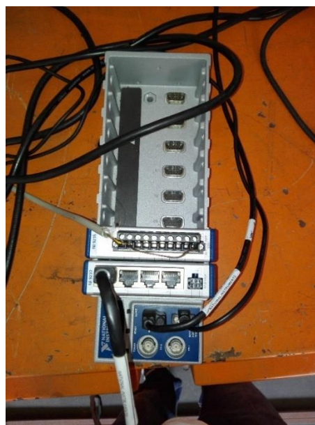
Figura 4.16-Placa de aquisição de dados NI9237 Figura 4.17- Chassis CompactDAQ da National Instruments ® com cartas NI9237 e NI9215.
