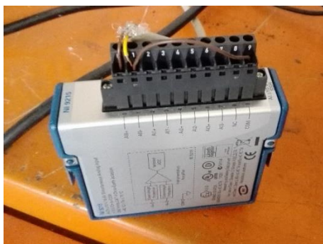
Figura 4.13- Placa de aquisição de dados NI9215 da National Instruments ®. Figura 4.14-Fonte de alimentação Escort EPS-3250.
