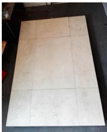
Figura 4.23-Vista superior após montagem das nove placas superiores.
