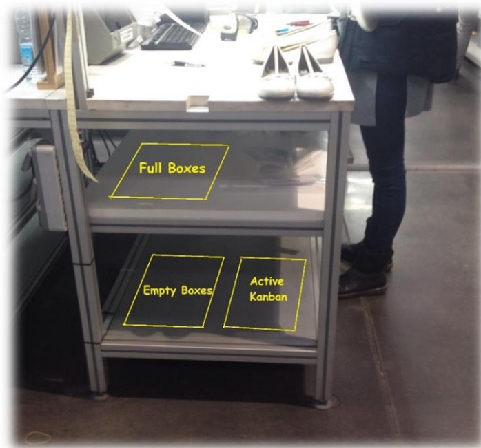
Figura 22 - Regras de armazenamento das caixas SUC para as varetas de plástico
