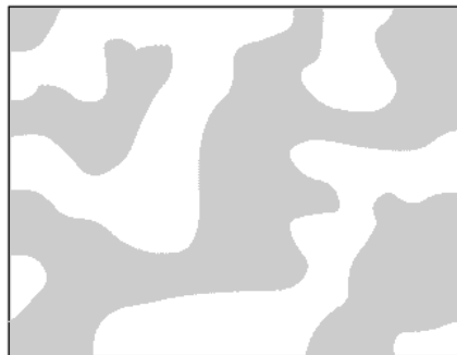
Figura 3. 2 representação bidimensional de um sistema constituído por duas fases distribuídas aleatoriamente, com densidades electrónicas diferentes, \rho_1 e \rho_2
