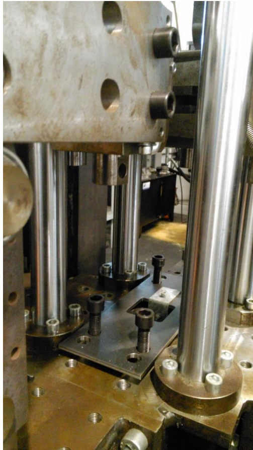
Figura 3.12 – Suporte do vídeo-extensómetro montado na máquina.
