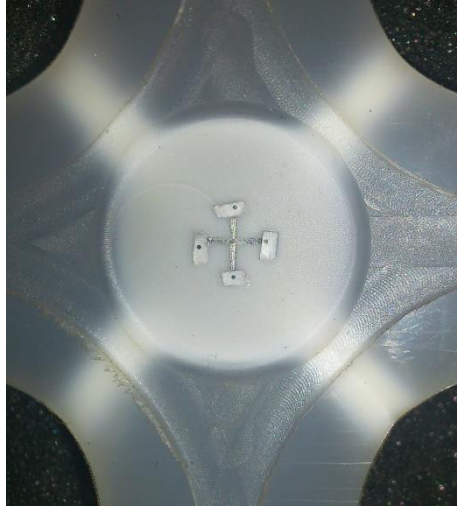
Figura 5.11 – Fotografia de provete cruciforme que mostra as zonas de concentração de tensões em branco mais vivo.
