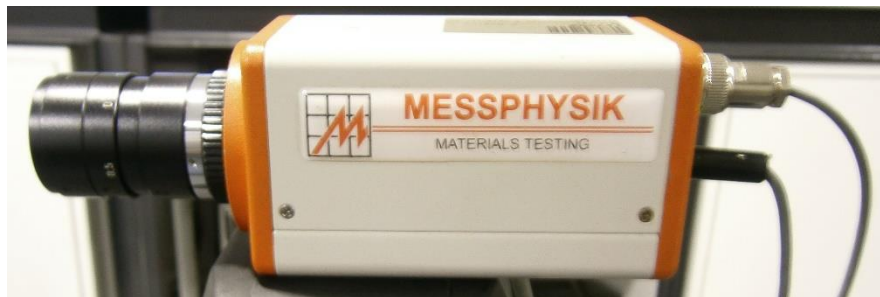
Figura 3.10 – Vídeo-extensómetro Messphysic ME 46 NG .
