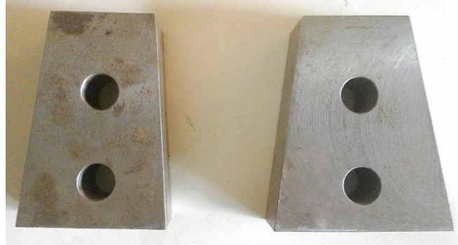
Figura 3.6 – Cunhas com diferentes inclinações da face de trabalho.
