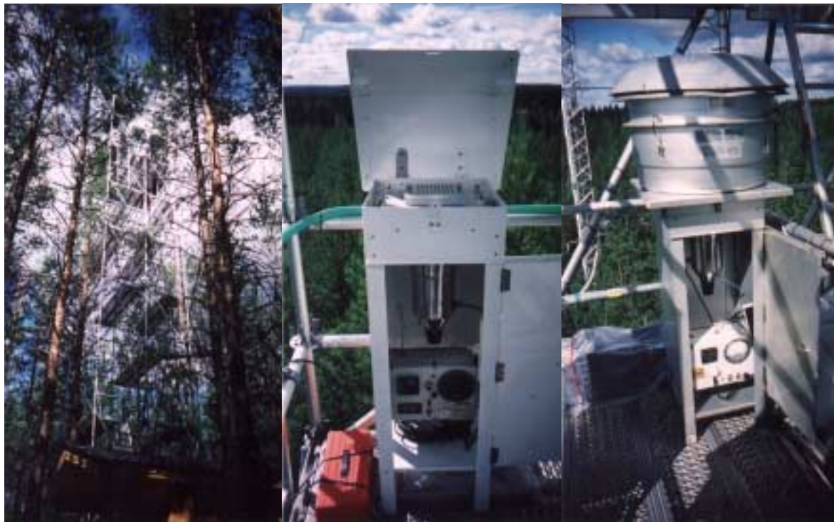
a) Torre de amostragem b) Amostrador com impactor em cascata c) Amostrador com cabeça de pré-separação
