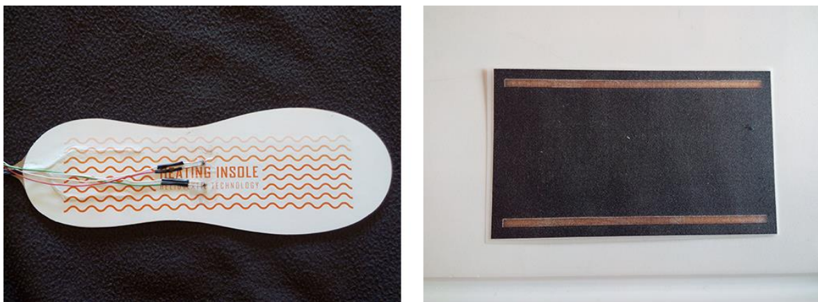
Figura 35: Banda disponibilizada, com 2 termístores à vista (à esq.). Banda sem qualquer tipo de ornamento (à dir.)
