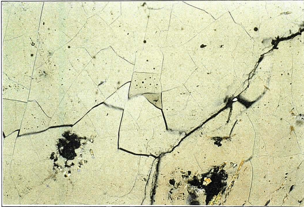
Figura 40- Observação microscópica de uma amostra de quartzo de Poço Palheiro - quartzo filoneano, um só grão e uma só orientação óptica. Não deformado e com muitas inclusões fluidas, clorite e moscovite.
