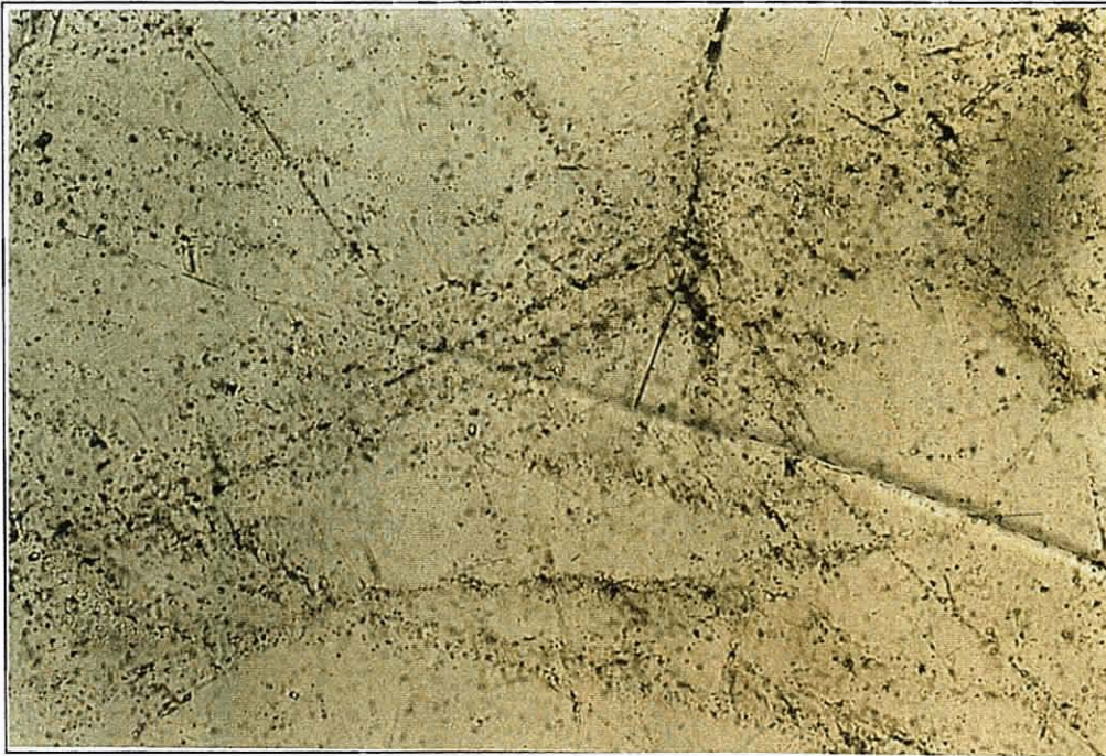
Figura 41 - Observação microscópica de uma amostra de quartzo de Freches - quartzo filoneano com muitos planos de inclusões fluidas e extinção ondulante.
