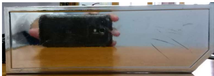
Figura 23-Peça de ABS revestida com alumínio por metalização em vácuo (PMV).
