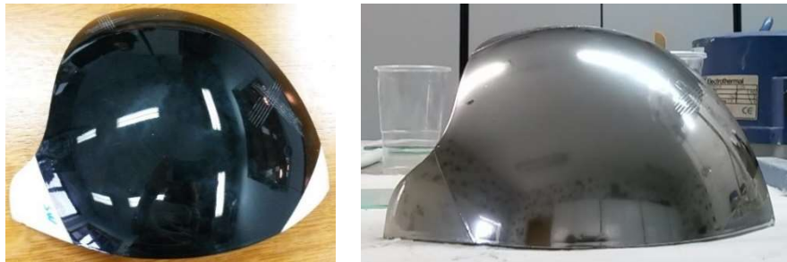
Figura 33- Amostra de ABS revestida com o revestimento acrílico negro de alto brilho (à esquerda) e, com o revestimento P2 (à direita).
