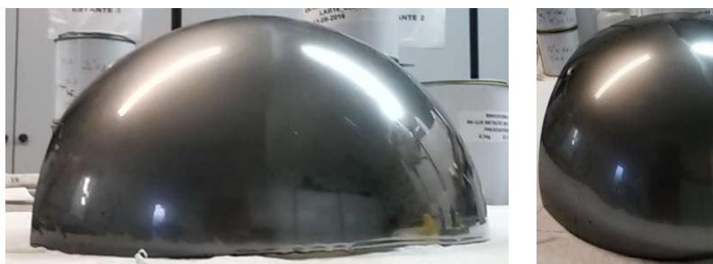
Figura 34- Amostra de ABS em que metade deste encontra-se revestido com TCA3_2 (lado esquerdo) e zona do capacete revestido com TCA3_2, com mais detalhe (lado direito).
