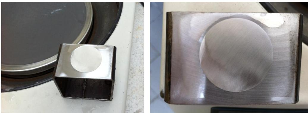
Figura 18: Preparação de uma amostra para observação em TEM
