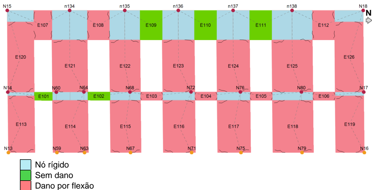
Figura 7.14 Tipos de dano (fachada SW) – Análise 13 – edifício original reforçado com tirantes [3Muri®, 2016]
