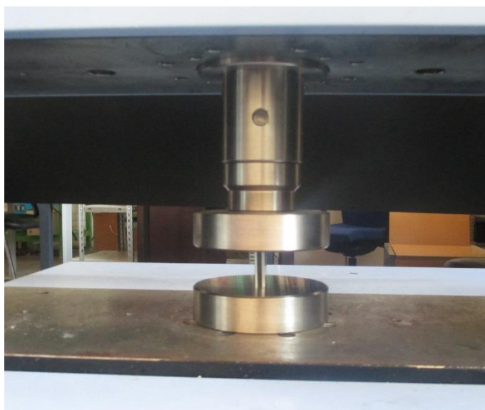
Figura 10: Fotografia de um ensaio de provete híbrido C20C com alumínio.
