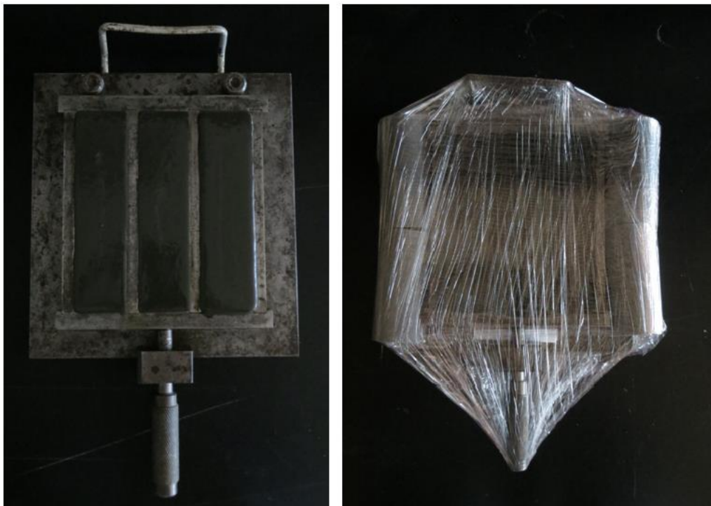
Figura 19. Moldagem dos provetes e preparação para condições de cura com película de “filme PVC”.
