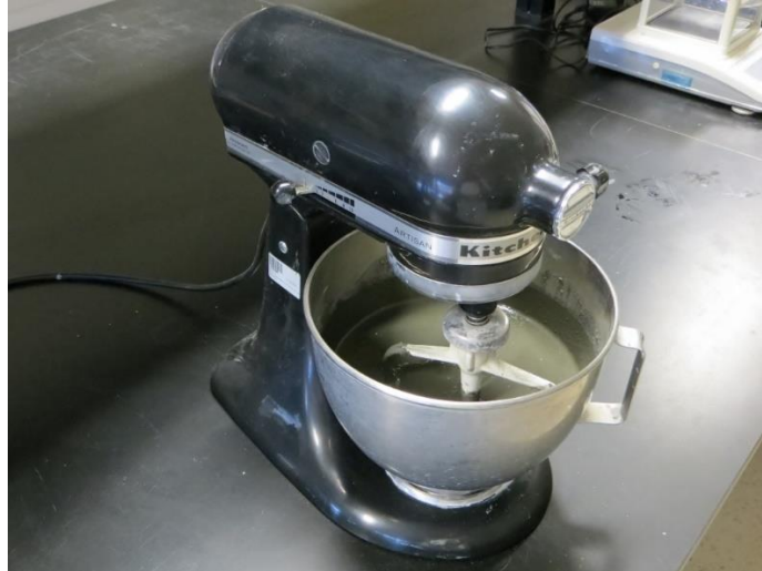
Figura 18. Equipamento de mistura mecânico utilizado na produção das argamassas.
