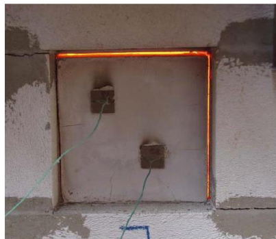
Figura 8. Placas fabricadas utilizando ligantes geopoliméricos sujeitas ao fogo (Torgal et al., 2011).
