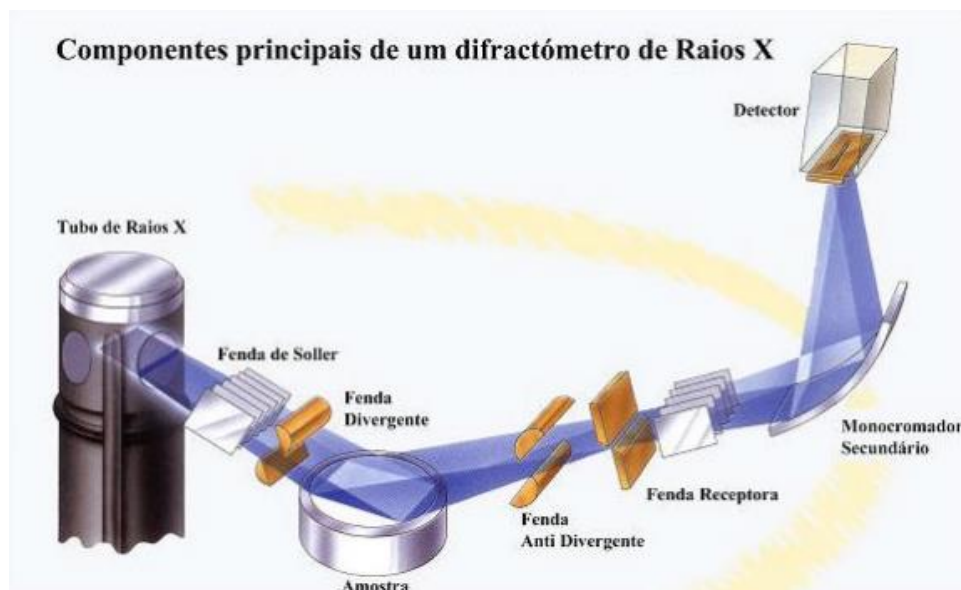
Figura 14. Esquema de um difratómetro de fonte linear e os seus componentes principais.
