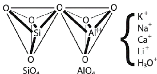
Figura 3. Conceito iónico da onfiguração tetraédrica do sialato Si-O-Al-O (Davidovits, 1979).
