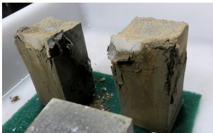
Figura 34. Degradação dos corpos de prova devido ao ensaio de absorção de água por capilaridade.
