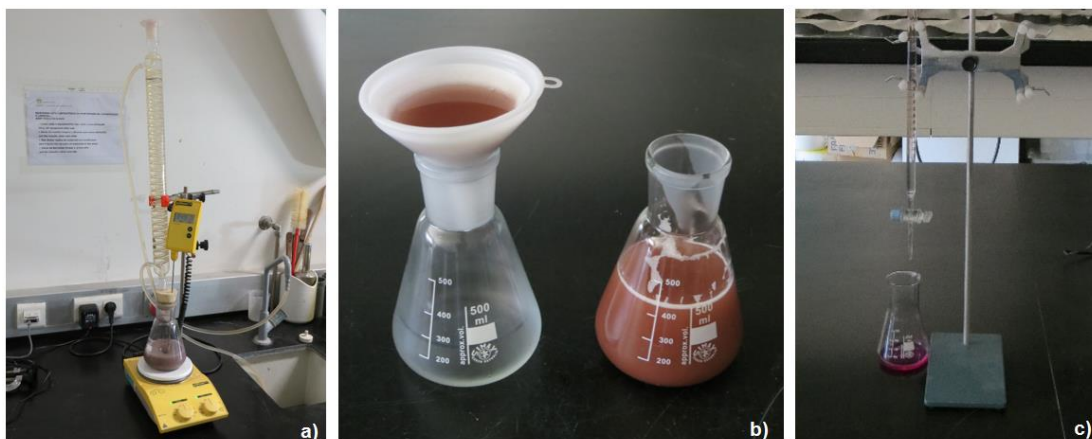
Figura 17.a) Disposição do equipamento afeto à primeira etapa do ensaio; b) filtração; c) titulação ácido-base.
