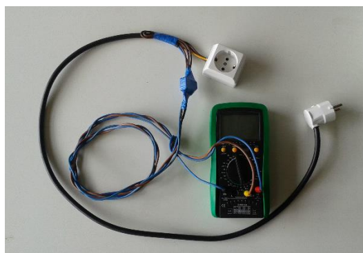
Figura 26 - Circuito elétrico de medição de V e I
