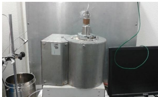
Figura 13 - Forno Tubular Horizontal
