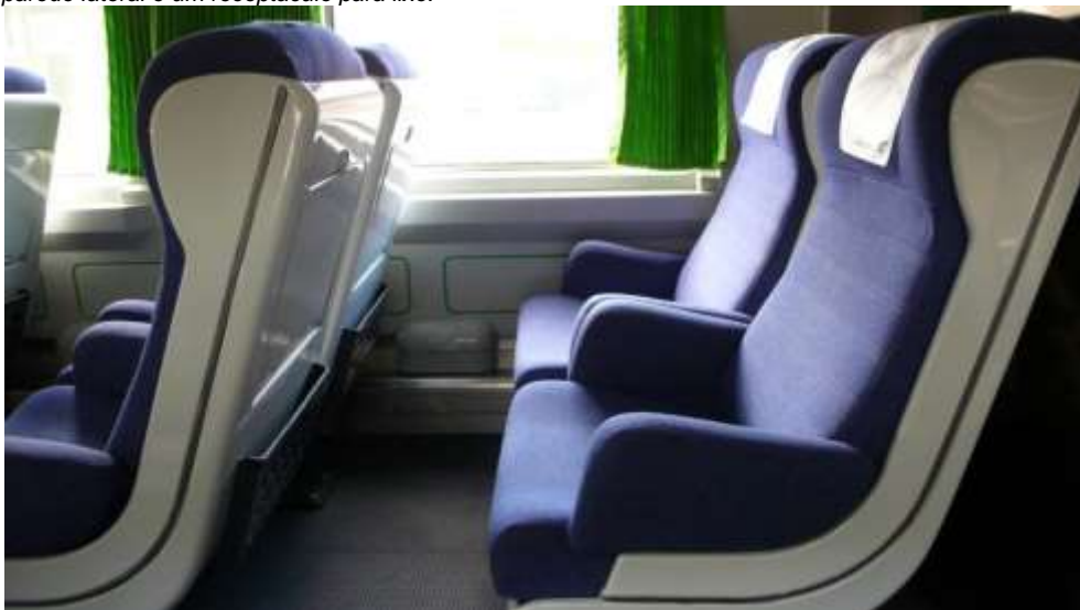
Fotografia 55. Poltronas SM1 unidireccionais geminadas.
