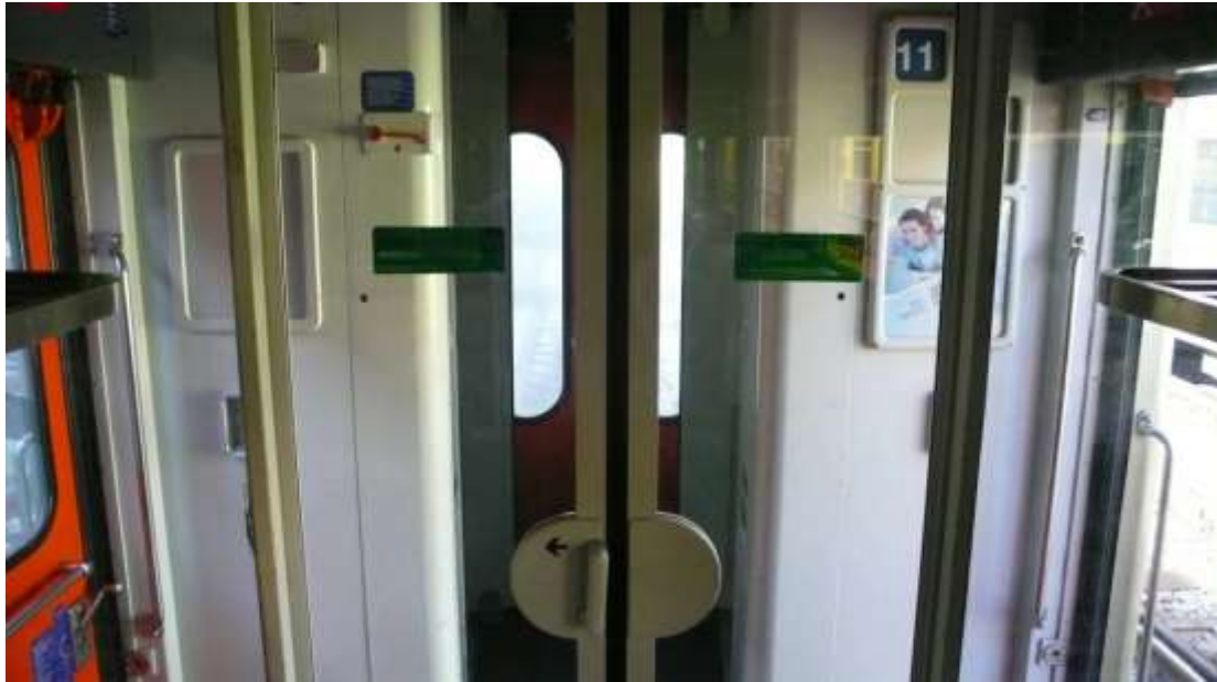
Fotografia 17. Átrio Corail1 visto do interior do salão de passageiros. Átrio do lado sul. Os dois corpos brancos que ladeiam o átrio são os cubículos de WC. As duas portas dos WC encontram-se abertas. Ao centro e ao fundo: a porta de intercomunicação.
