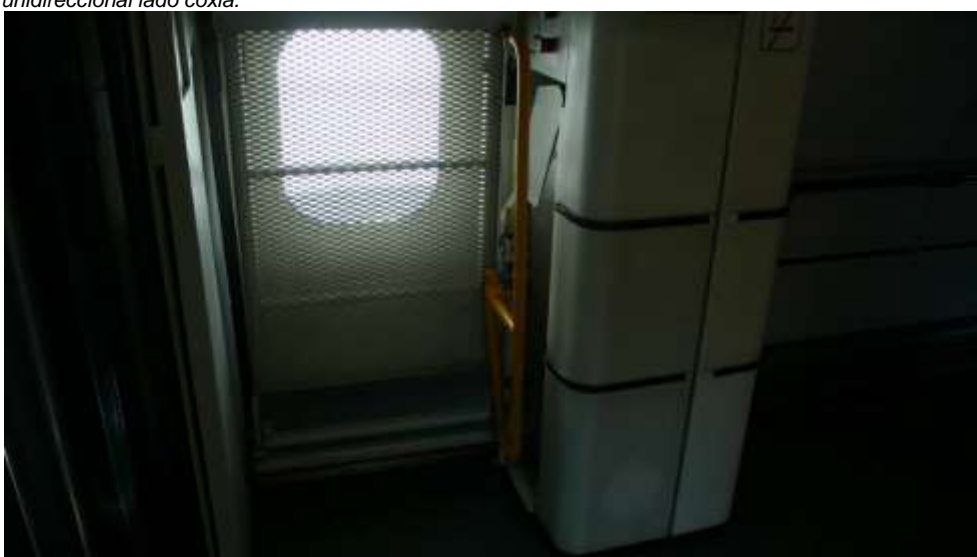
Fotografia 111. Plataforma elevatória instaladas no interior das duas escotilhas de embarque para PMR (carruagem 4, átrio Sul).
