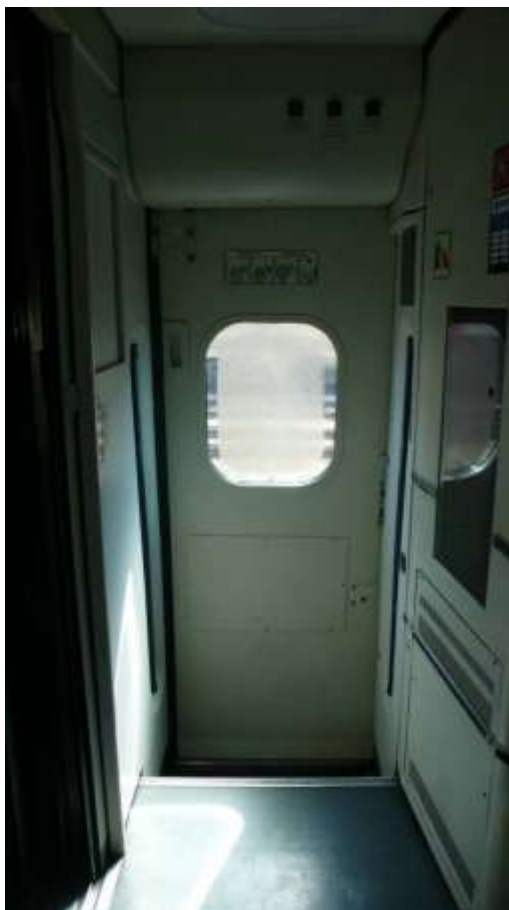
Fotografia 119. Porta de embarque CPA. À esquerda observa-se a porta de intercomunicação (aberta).
