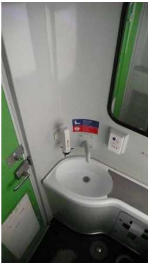
Fotografia 11 Interior do cubículo do WC Corail. À esquerda observa-se a porta (verde) do cubículo. Corpo circular no pavimento: pedal de accionamento da torneira. Acima do tampo do lavatório observa-se o espelho.
