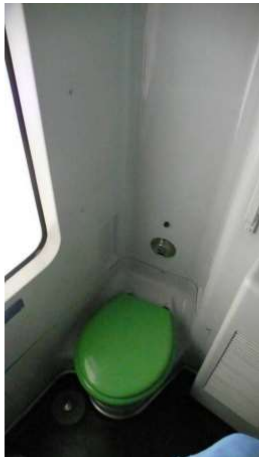
Fotografia 12. Interior do cubículo do WC Corail. Corpo circular metálico no pavimento: pedal de accionamento da descarga de água para a sanita.
