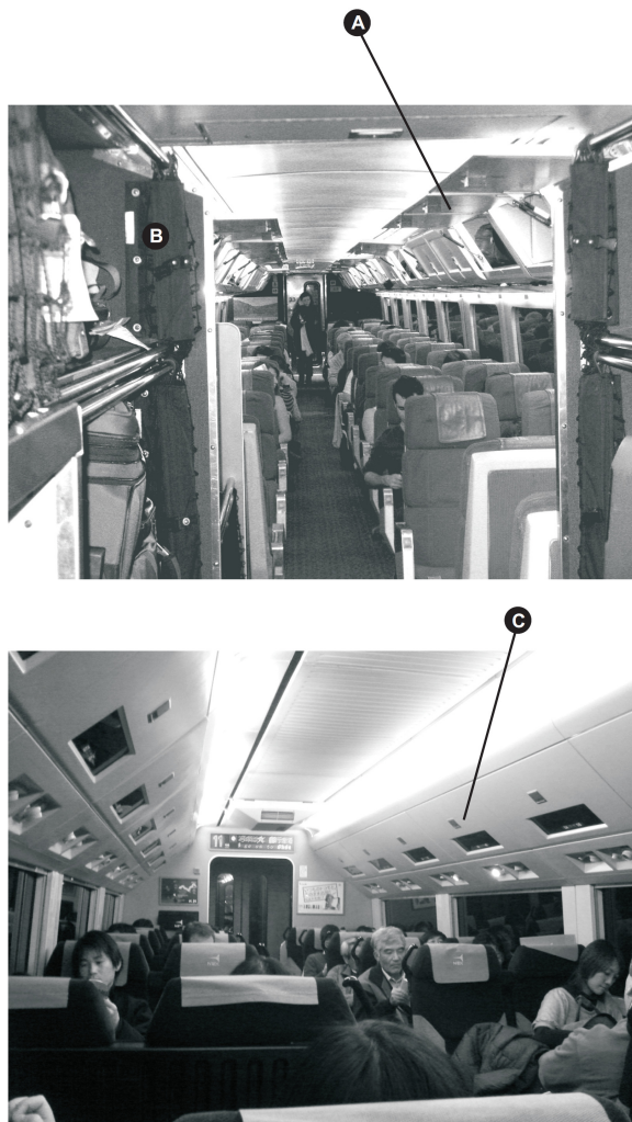
Figura 27. Habitáculos com bagageiras longitudinais compartimentadas e com portas para retenção da carga. Fotografias de uso livre descarregadas de flickr.com em 02/09/2013. v. autores, adaptadas. (A) bagageiras com a tampa aberta, habitáculo LRC-ViaRail Canadá; (B) bagageira no topo do salão com cortina (aberta) para retenção da carga; (C) bagageira com a tampa fechada, habitáculo NaritaExpress-JR Japão.
