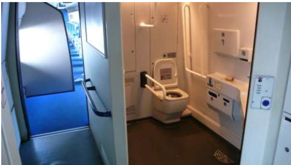
Fotografia 112. Cúbiculo de WC CPA para PMR (carruagem 4, átrio Sul).
