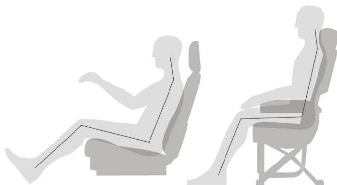
Figura 29. Posturas típicas de um condutor de um veículo automóvel ligeiro e de um passageiro da classe turística de um avião comercial.
