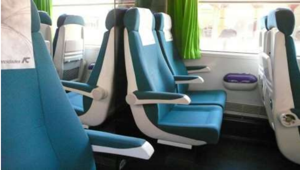
Fotografia 39. Poltronas unidireccionais Corail2 no centro da carruagem. Observa-se a divisória acústica (painel de vidro) instalada entre as duas filas de poltronas mais à esquerda.
