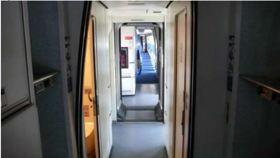
Fotografia 93. Salão CPA1 (Carruagem 1). Aspecto do extremo Norte. Observam-se as bagageiras baixas áquem da porta de fecho do salão (a porta encontra-se aberta). Nos bordos inferiores das bagageiras podem observar-se os cadeados para prisão da bagagem. Além da porta de fecho do salão observa-se: um cubículo de WC com a porta aberta à esquerda, e outro com a porta fechada, à direita.
