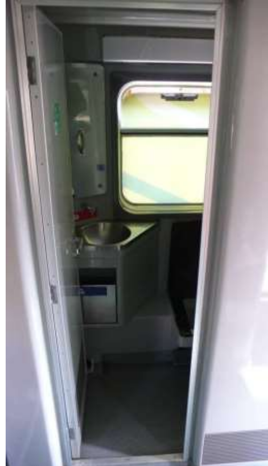
Fotografia 49. Porta de cubículo WC SM. A superfície à esquerda da janela, e por cima do lavatório, é um espelho.
