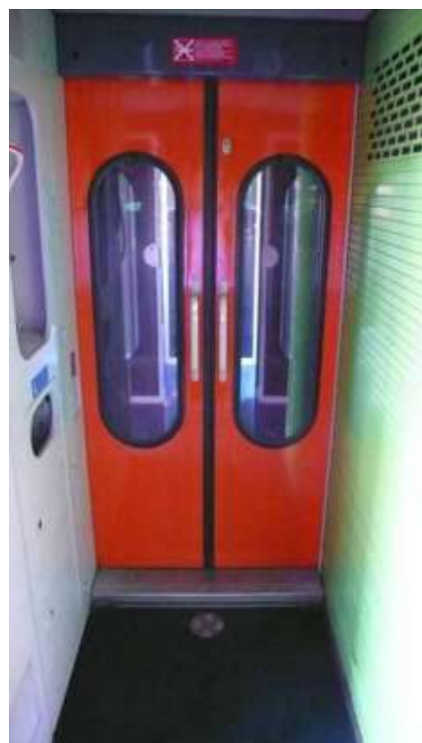
Fotografia 16. Porta de intercomunicação Corail1 vista do interior.
