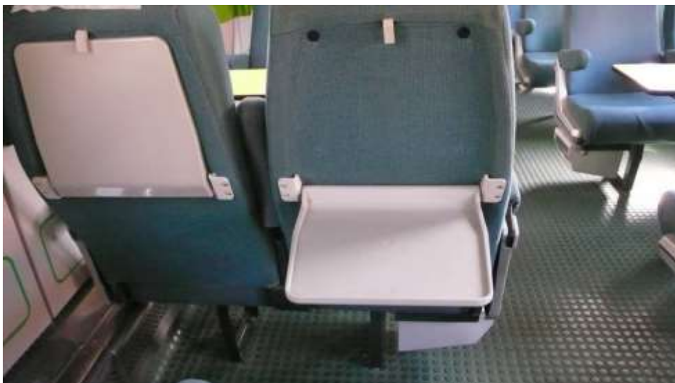
Fotografia 82. Poltrona SM2. Aspecto da mesa individual aberta. Observa-se ao fundo e abaixo a obstrução causada pelo receptáculo para o lixo (instalado sob o assento).
