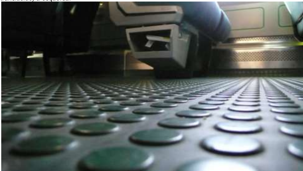
Fotografia 75. Poltronas SM2. Receptáculo para o lixo instalado sob o assento (a cada duas filas de poltronas).
