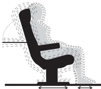
Figura 55. Transmissão de vibrações carruagem-poltrona-passageiro
