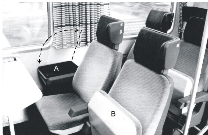
Figura 11. Interior da carruagem Interregio-DB incluída no estudo de Kottenhoff 1993. Fonte: Kottenhoff 1993, adaptado. (A) mesa rebatível possível de transformar em assento para crianças. (B) poltrona com assento rebatível para facilitar movimentação dos passageiros.
