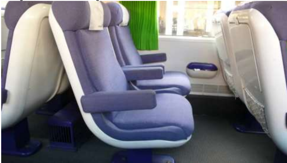
Fotografia 21. Poltrona Corail1 unidireccional.
