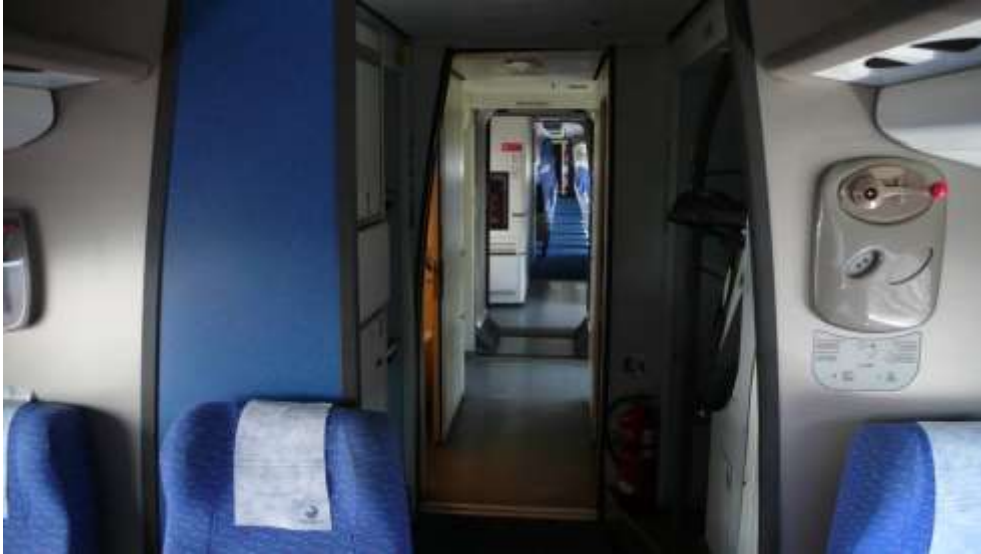
Fotografia 92. Salão CPA1 (Carruagem 1). Aspecto do extremo Norte. Observam-se as bagageiras baixas áquem da porta de fecho do salão, e o cubículo de WC (Porta aberta) além da porta de fecho, à esquerda.
