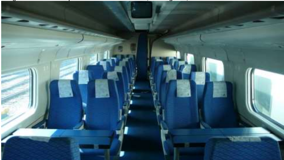
Fotografia 116. Aspecto do extremo Sul do salão da carruagem 4. Ao fundo e à direita observa-se o painel de partição que faz o remate da bagageira longitudinal do lado Oeste do salão. As poltronas para PMR são as duas mais distantes do fotógrafo, à esquerda da imagem.
