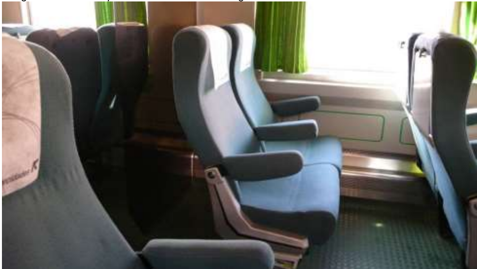
Fotografia 74. Poltronas SM2 unidireccionais geminadas. Note-se a divisória acustica (painel de vidro translúcido) à esquerda.
