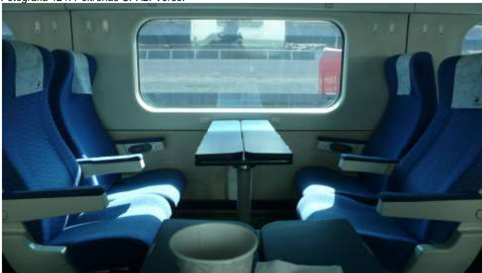
Fotografia 122. Poltronas CPA2 frente-a-frente. A poltrona mais próxima do fotógrafo, à direita, encontra-se na posição "reclinada".
