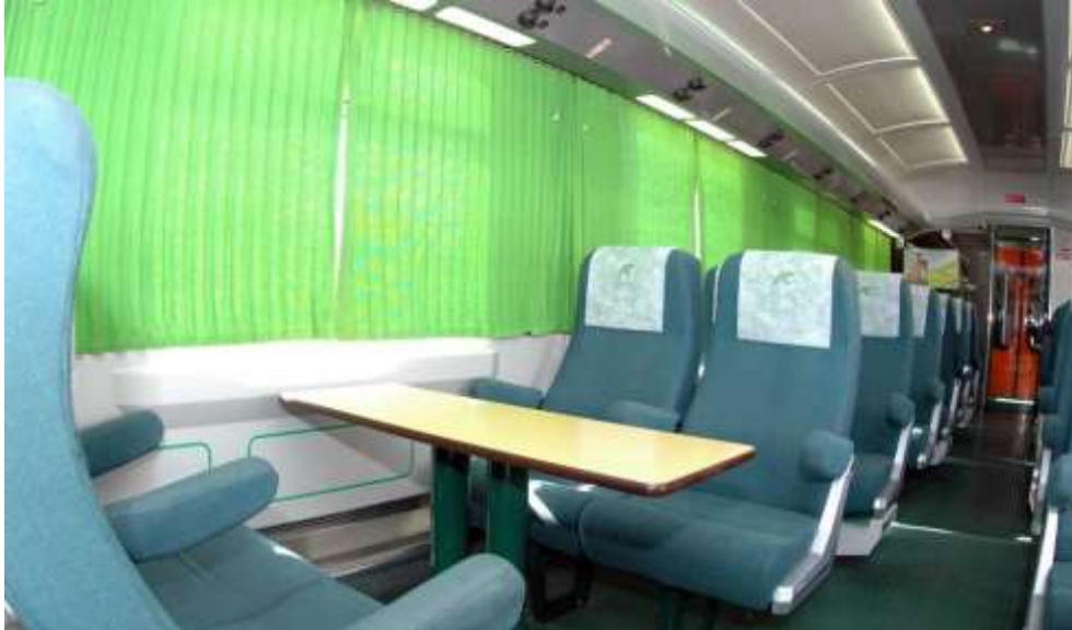
Fotografia 76. Poltronas SM2 frente-a-frente. Observa-se a instalação dos receptáculos para o lixo sob o assento das filas mais recuadas na fotografia. Observa-se o alinhamento das luminárias sob a bagageira longitudinal com as janelas (parcialmente ocultas pelas cortinas).
