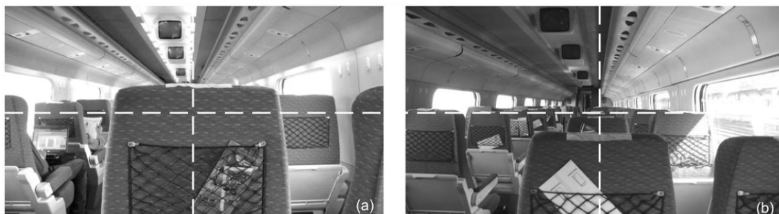
Figura 85. Habitáculo CPA classe conforto. Campo visual central aproximado de um passageiro com os olhos a (a) 700 mm do assento e (b) 800mm do assento.
