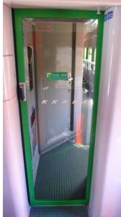
Fotografia 68. Compartimento-bar SM. Porta de fecho (transparente) do compartimento no lado Norte. Aspecto para o passageiro chegado da 2ª classe. A porta cinzenta ao centro é o acesso ao interior da copa (note-se o degrau).
