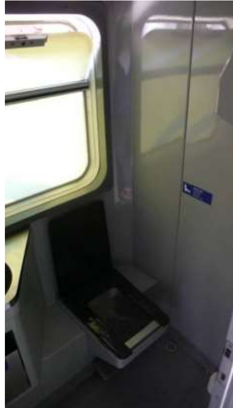
Fotografia 51. Interior do cúbiculo WC SM. O plano metálico semi-oculto sob a sanita é o pedal de accionamento da descarga de água.
