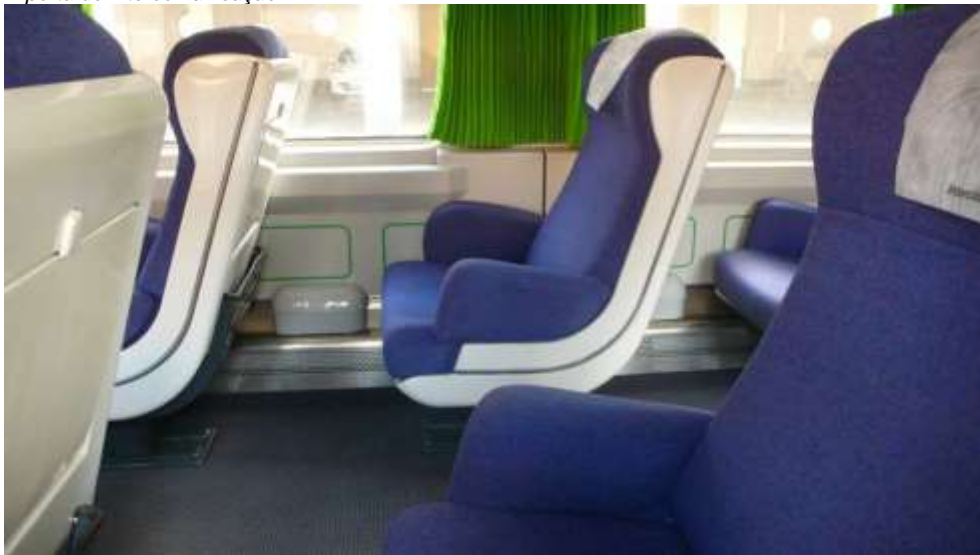
Fotografia 54. Poltrona SM1 unidireccional isolada. O corpo à frente do assento e montado sobre a parede lateral é um receptáculo para lixo.
