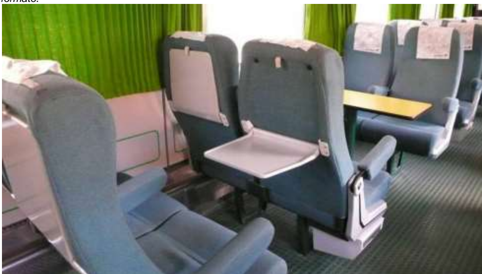
Fotografia 81. Poltronas SM2. Aspecto da mesa individual aberta. Observa-se o bordo saliente do tampo da mesa e a ausência de "porta-revistas".
