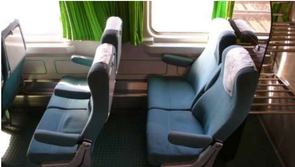
Fotografia 79. Poltronas SM2 unidireccionais no extremo Noroeste do salão. À direita observa-se a bagageira baixa que oculta parcialmente a janela.
