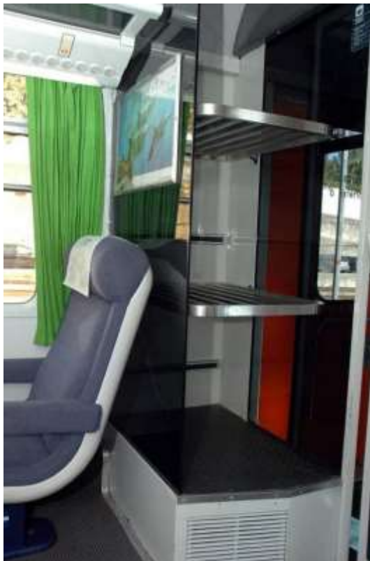
Fotografia 18. Bagageira baixa no extremo de um salão Corail1
