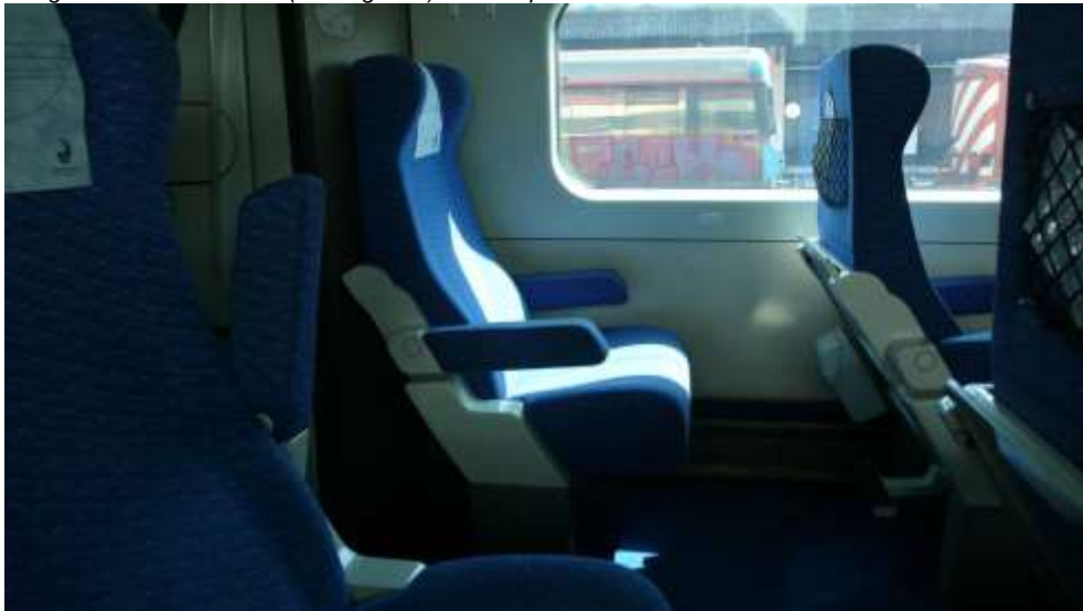
Fotografia 90. Poltrona CPA1 isolada e unidirecional.
