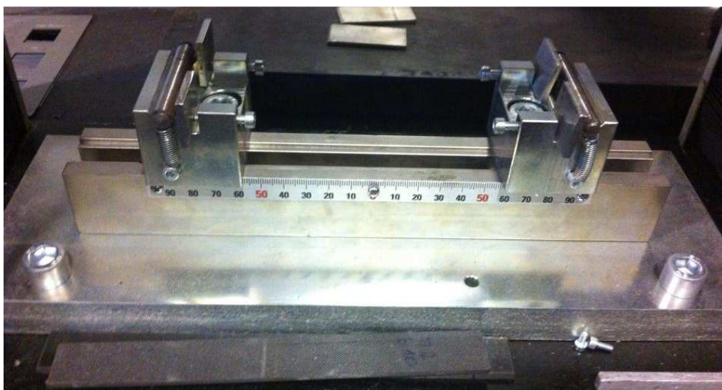
Figura 2.19 - Componentes de fixação do provete na sua largura acoplados ao carril.
