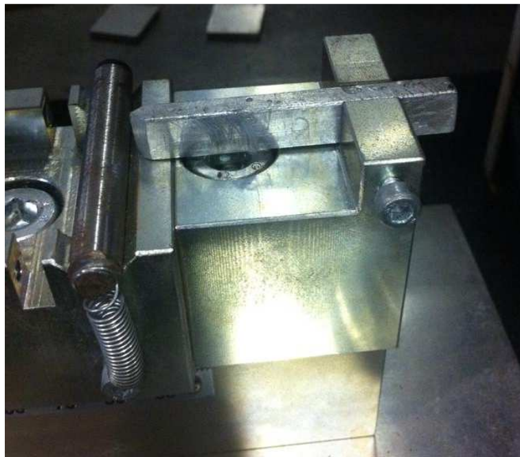
Figura 2.21 - Sistema de posicionamento na direção do comprimento do provete.
