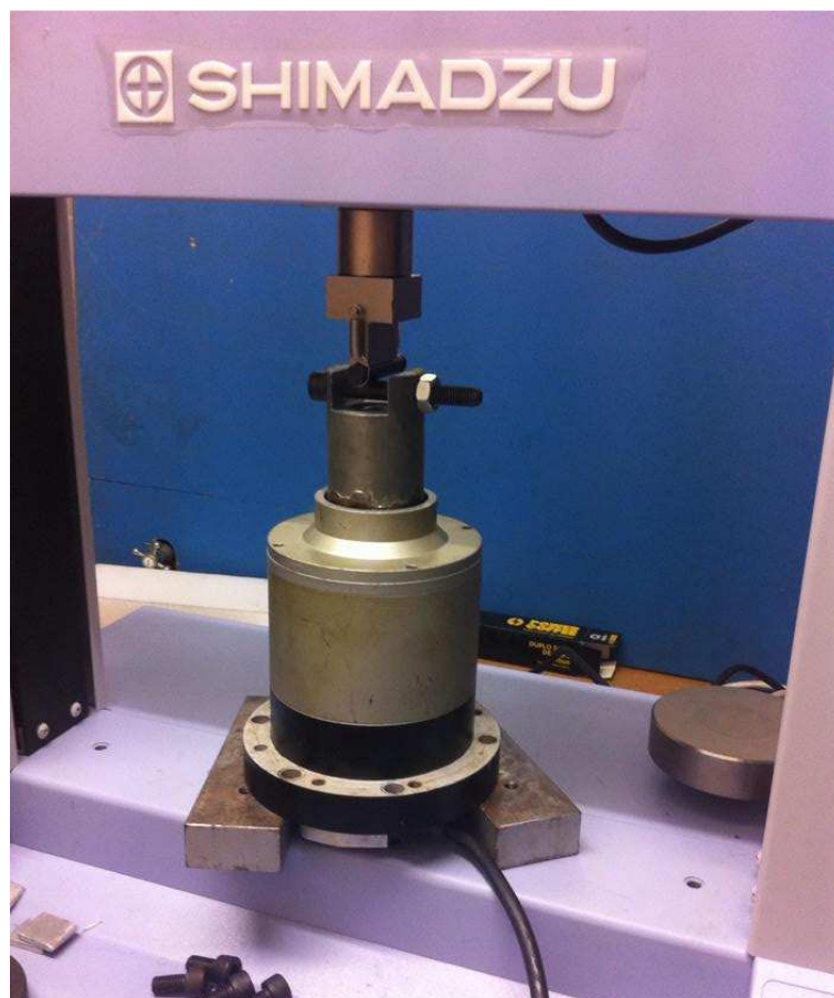
Figura 3.2 - Calibração da célula de carga na ShimadzuTM AGS-X STD.
