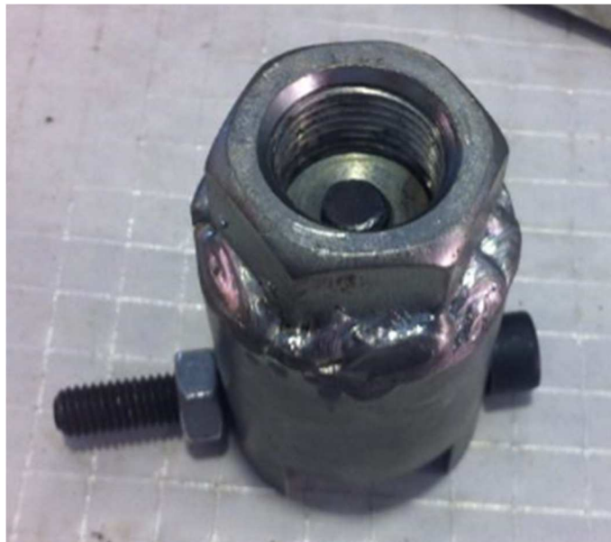
Figura 2.24 - Fixador a ligar ao travessão da MEF.
