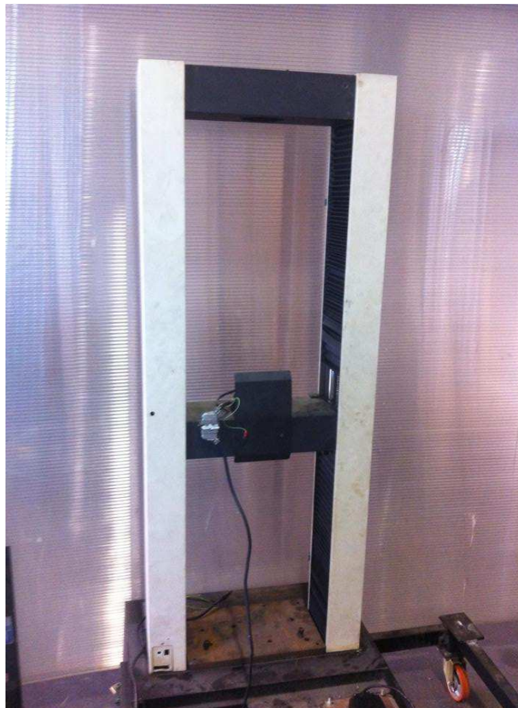
Figura 2.1 - Estrutura Inicial da máquina de ensaios de fadiga.
