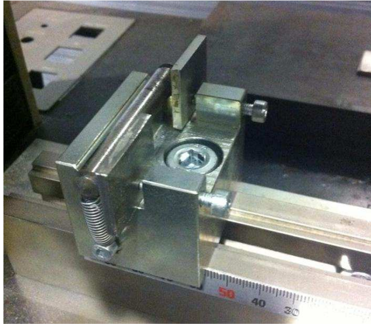
Figura 2.20 - Sistema de posicionamento na direção da largura do provete.
