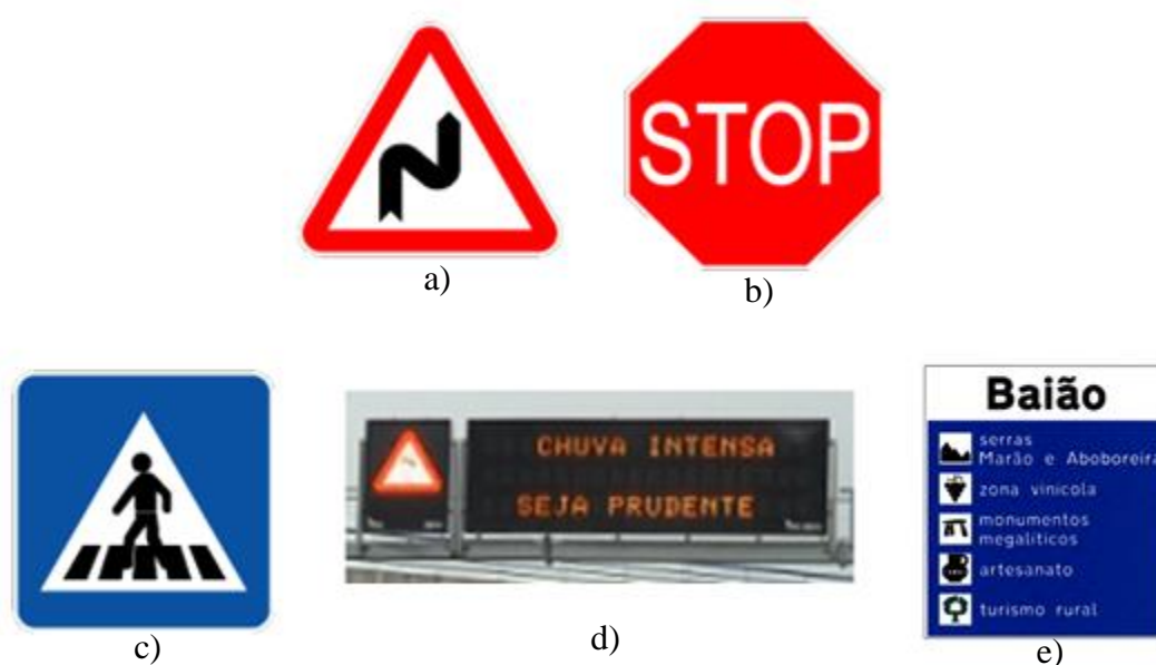
Figura 60. Exemplo de sinalização vertical: a) sinal de perigo; b) sinal de regulamentação; c) sinal de indicação; d) sinal de mensagem variável; e) sinalização turístico-cultural (Fonte: InIr, s.d.d; Ascendi; www.bomcondutor.pt )
