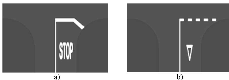
Figura 56. Exemplos de marcas transversais: a) linha de paragem STOP; b) linha de cedência de passagem (Fonte: InIr, s.d.d)
