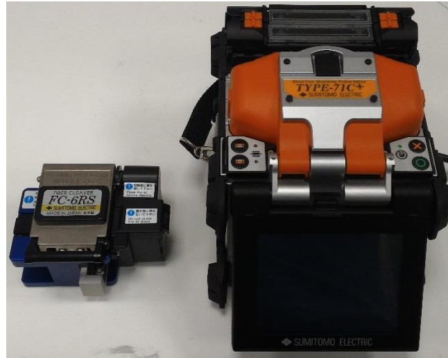
Figura 4.16 – Máquinas de clivagem (à esquerda) e fusão (à direita) de fibras óticas (SUMIMOTO ELECTRIC, modelos FC-6RS e TYPE-71C, respetivamente).
